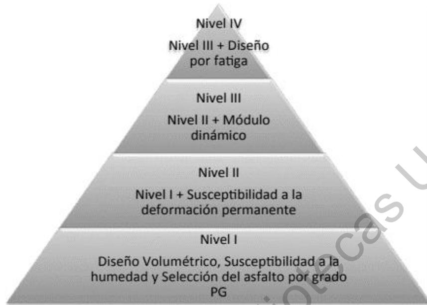
**Figura 2 Criterio de Selección de ensayos para la evaluación del diseño de mezclas asfálticas**
