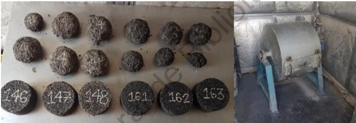
**Figura 21 Probetas ensayadas al Cántabro**
