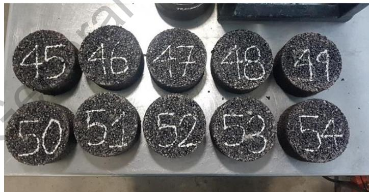
**Figura 19. Muestra de las probetas fabricadas**
