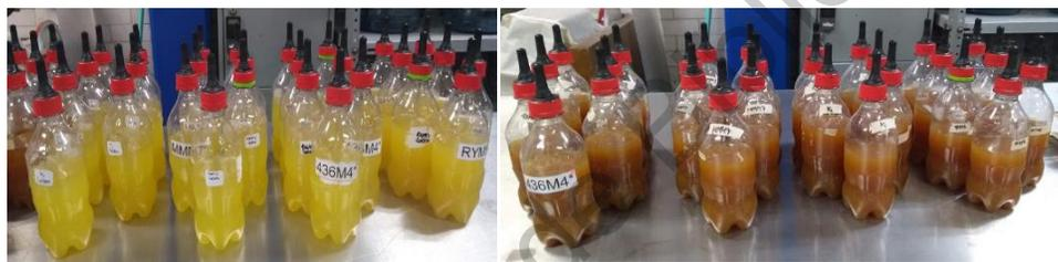
**Figura 3.2.** Dispositivos en las botellas para el monitoreo de la evolución de la segunda fermentación de las diferentes cepas de levadura para la obtención de sidra espumosa
