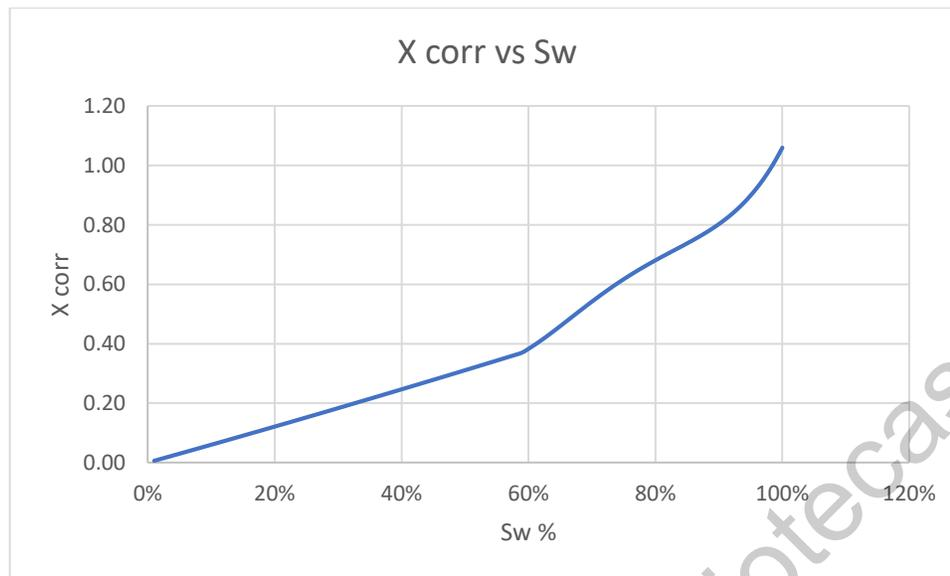
Figura 7.15 Relación entre grado de saturación y valor  $\chi_{corr}$  para trayectoria de secado obtenido del modelo de Rojas.
