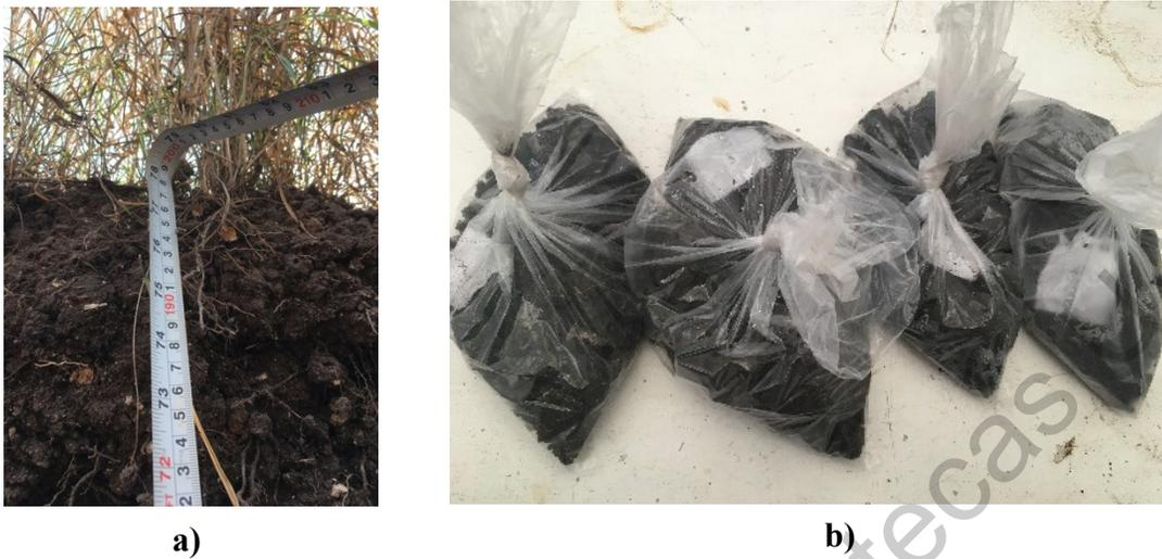
Figura 6.4 a) Medición desde la superficie para obtención de muestras alteradas. b) Muestras alteradas a cada 50 cm desde la superficie.
