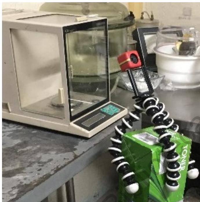
Figura 6.14 Cámara para grabar el proceso de medición de masa de los papeles filtro.
