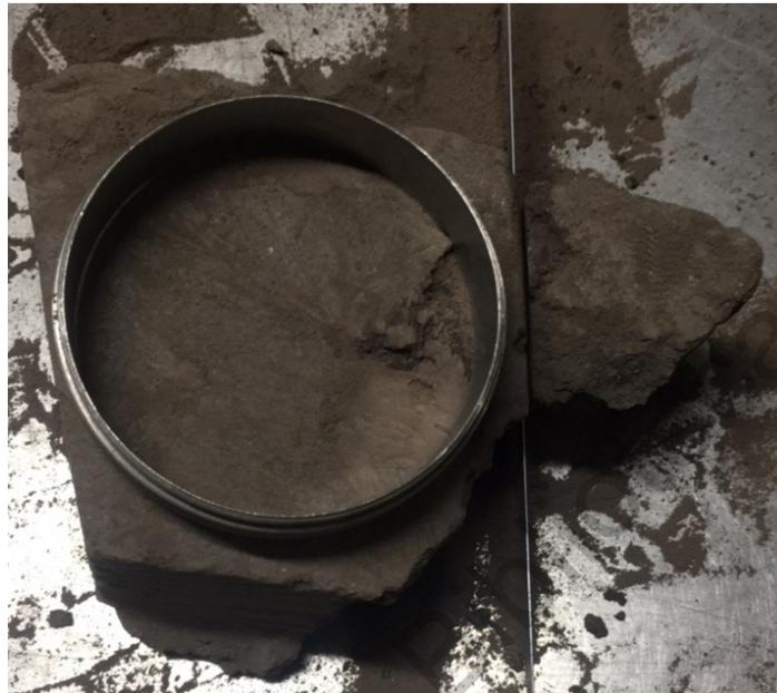
Si la muestra que se va a utilizar será completamente seca entonces se procede a colocar el rectángulo del paso anterior en el horno de secado por al menos 24 horas. Una vez seco continuar con el siguiente paso.
