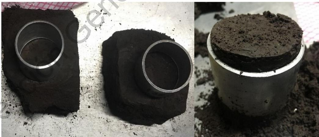
Figura 6.17 Labrado de muestras inalteradas para prueba de succión.
