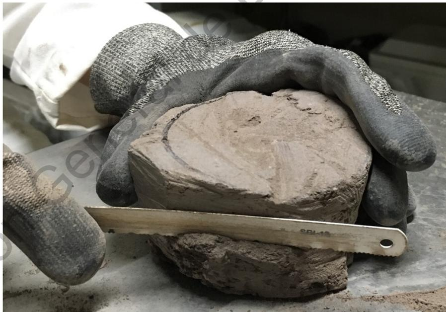
Conforme se va cortando la pieza es importante revisar continuamente si el corte va de forma correcta, esto se realiza colocando el anillo de consolidación encima y revisando que no se haya pasado.
