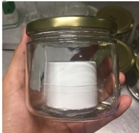
Figura 6.13 Elemento inerte para aislar el papel filtro de la solución.
