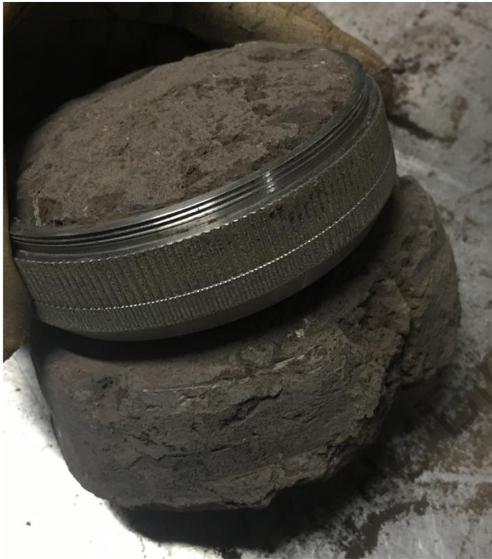
Figura 6.19 Labrado de muestra inalterada en el anillo de consolidación.
