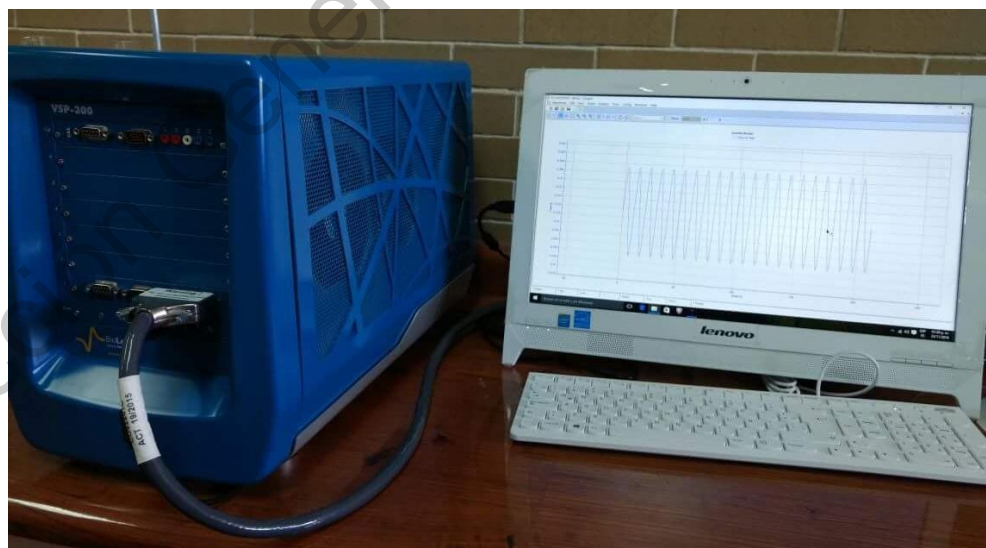
Figura 7. Potenciostato marca Bio- Logic modelo VSP-300.
