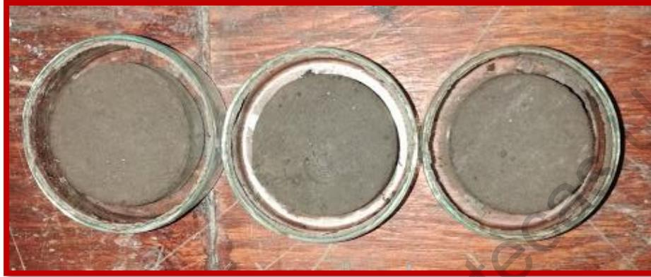
**Figura 3.28.** Determinación del límite de contracción volumétrica en suelo con contaminante.
