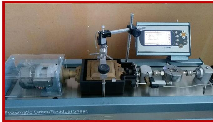
**Figura 3.30.** Determinación de la resistencia al esfuerzo cortante.
