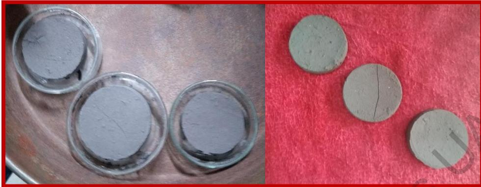
**Figura 3.25.** Determinación del límite de contracción volumétrica.
