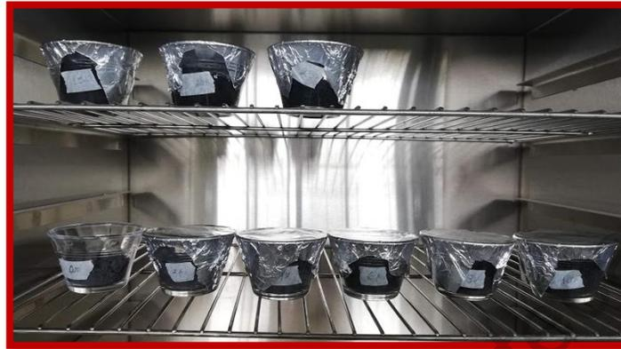
**Figura 3.31.** Material contaminado en diferentes porcentajes con respecto al peso seco del suelo.
