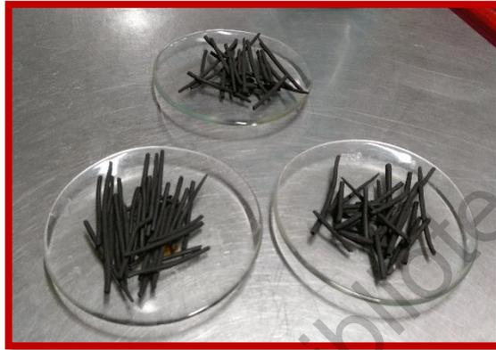
**Figura 3.23.** Determinación del límite plástico.
