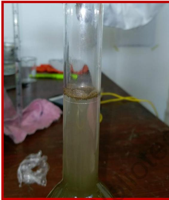
**Figura 3.16.** Espuma generada en la línea de aforo del matraz.
