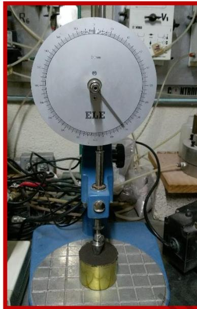
**Figura 3.22.** Determinación del límite líquido mediante cono inglés.
