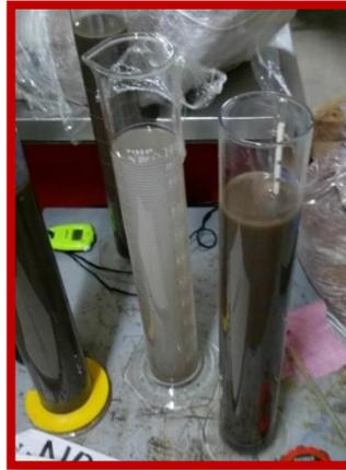
**Figura 3.19.** Análisis granulométrico por hidrómetro.
