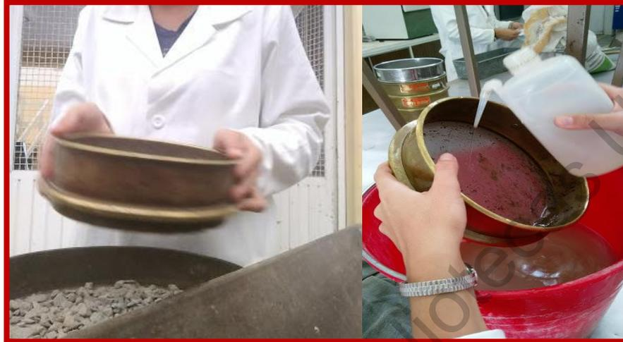
**Figura 3.18.** Análisis granulométrico por tamizado.
