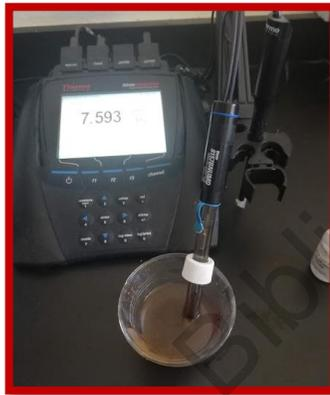
**Figura 3.8.** Determinación del pH del suelo.
