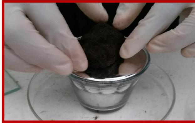
**Figura 3.12.** Determinación del peso específico del suelo.
