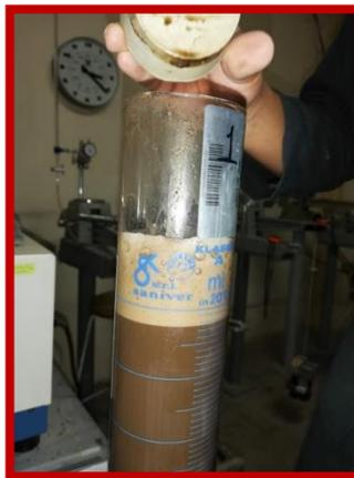
**Figura 3.20.** Espuma generada durante la prueba de hidrómetro.
