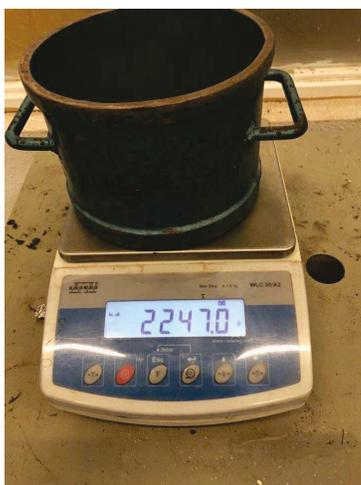
Figura III-15.- Prueba peso volumétrico seco suelto.
