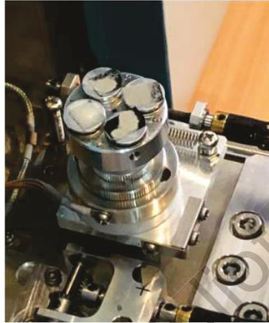
Figura III-19.- Muestras de cemento y zeolita en molde correspondiente de microscopio.
