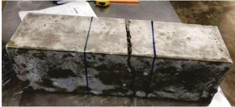
Figura III-24.- Ensayo a flexión de vigas.
