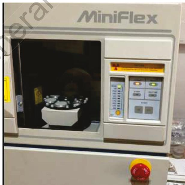
Figura III-17.- Muestras en el difractor.
