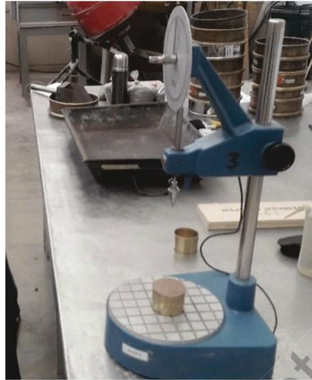
Figura III-5.- Prueba limite líquido cono inglés.
