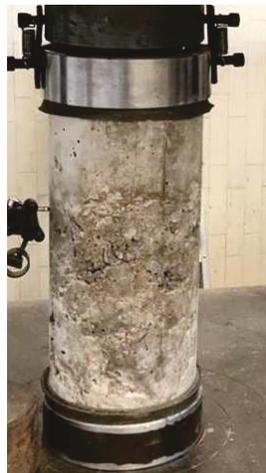
Figura III-21.- Aplicación de carga a cilindro de concreto.
