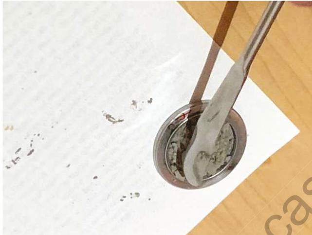
Figura III-16.- Colocación de cemento en porta muestras.
