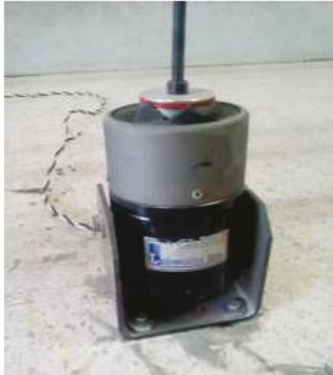
**Figura 2.1.** Vibrador electrodinámico, (Moreno *et al.*, 2018).
