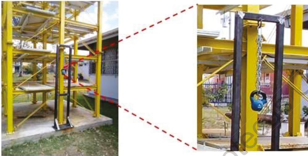
**Figura 3.6.** Sistema de excitación propuesto inicialmente para la estructura de marcos rígidos, péndulo con masa de 4 kg.
