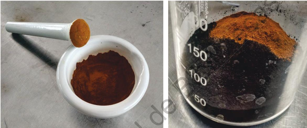
**Figura 6:** A la izquierda, óxidos de hierro pulverizados. A la derecha, carbón activado y óxidos de hierro previo a la molienda mecánica.
