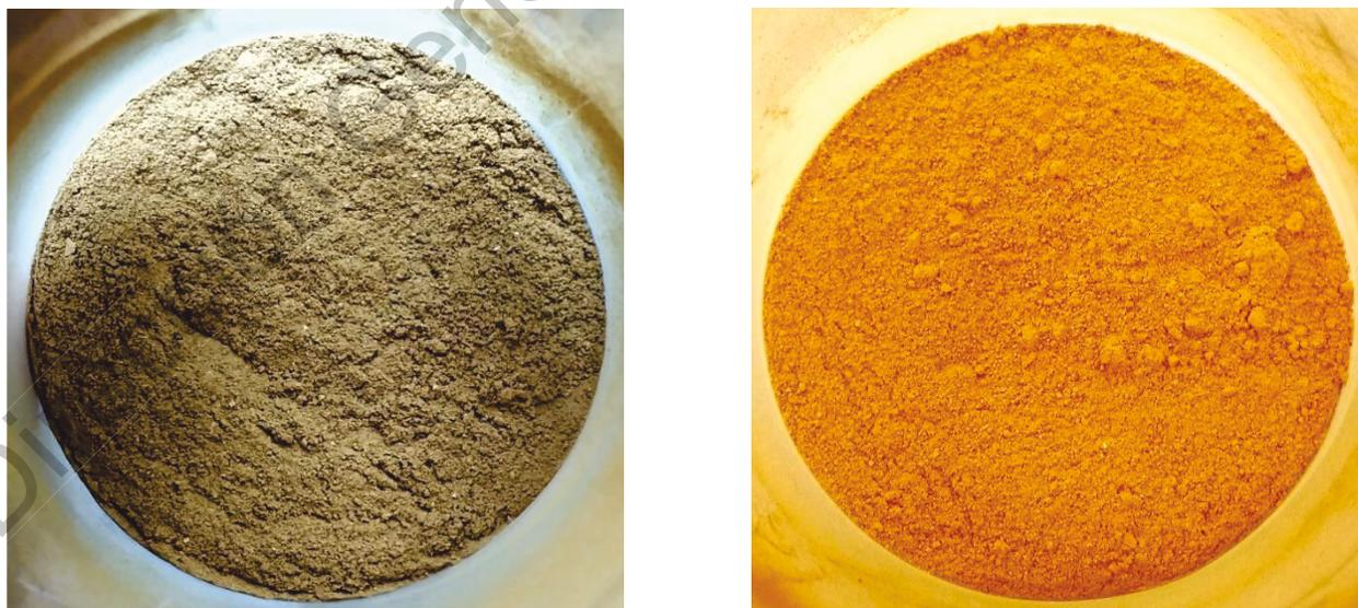
**Figura 8:** Óxidos de hierro sintetizados mediante la técnica top-down.
