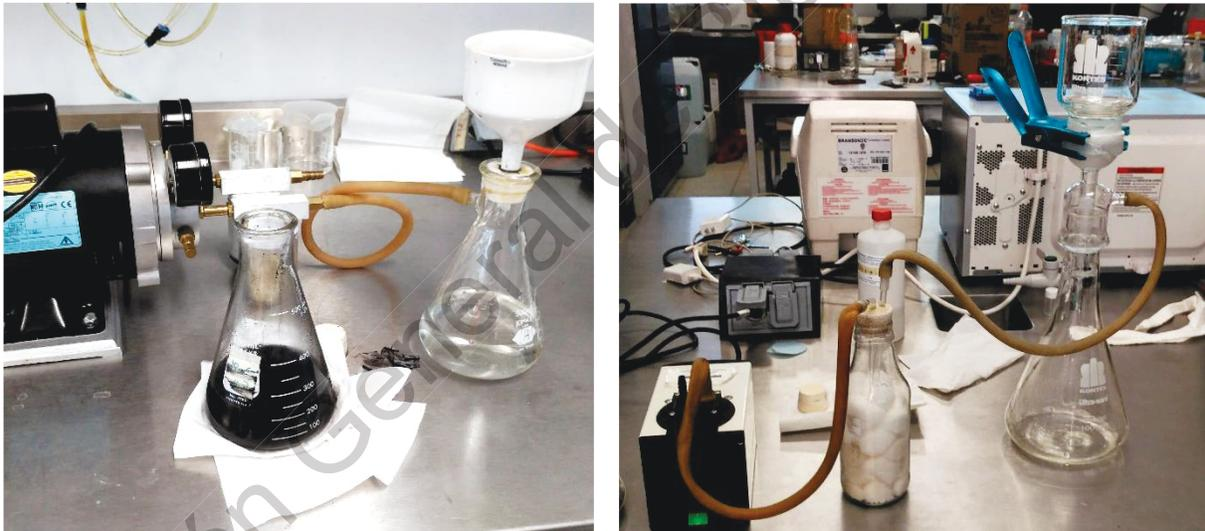
**Figura 7:** A la izquierda el sistema de filtrado con bomba de vacío y papel filtro; a la derecha el sistema de filtrado con bomba de vacío y membrana de nylon.
