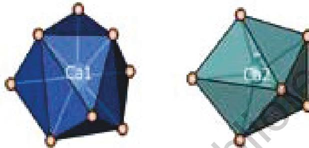
Figura 2.4 Átomo de Calcio Tipo I rodeado de 9 átomos de oxígeno en forma de prisma triangular triapuntado (izquierda) y átomo de Calcio Tipo II rodeado de 7 átomos de oxígeno en forma de bipirámide pentagonal ideal (derecha) (Campa *et al.*, 2007).
