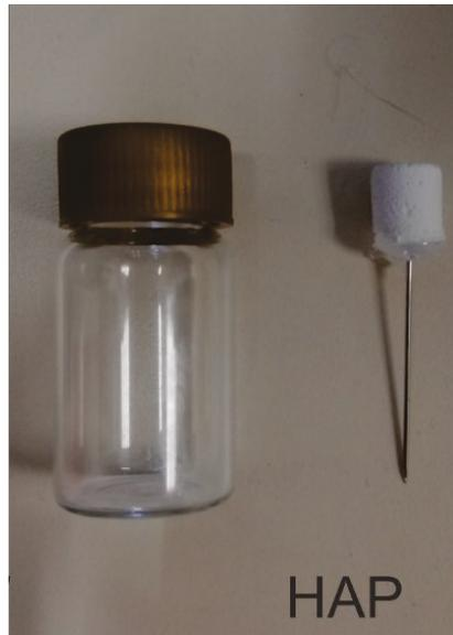
**Figura 3.7** Muestra de un material compuesto en su montaje previo al análisis por microtomografía.
