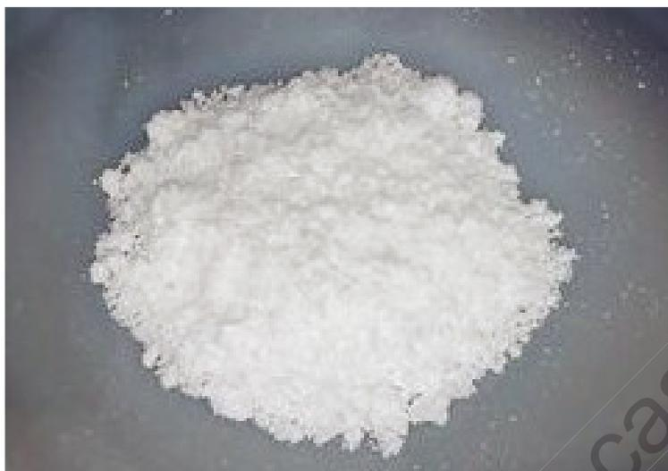
**Figura 3.2 HAp sintetizada mediante el método hidrotérmal asistido por microondas**
