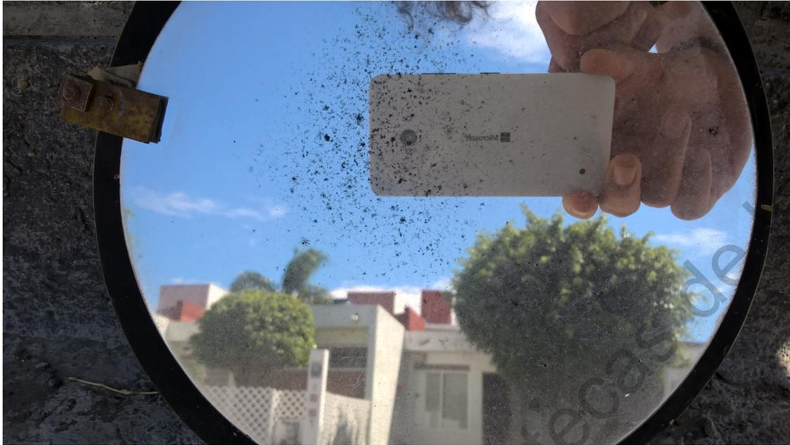
Veamos el último caso, cuando el objeto está colocado delante del espejo entre su vértice y su foco. Aquí la imagen es virtual, se apreciará como si estuviera detrás del espejo, y ampliada. La fotografía fue tomada a unos 50 cm de distancia y otros 40 cm de elevación con respecto al eje del espejo; captó la imagen de un poco de pasto a unos 25 cm del espejo y puede apreciarse que su imagen virtual es más grande, no invertida y equidistante, como si estuviese detrás del espejo.
