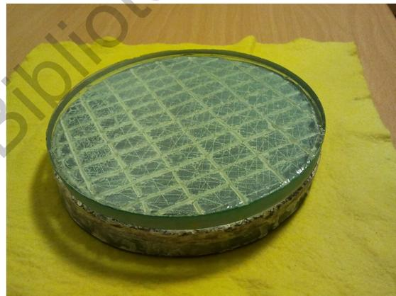
El objetivo es lograr una superficie esférica uniforme —o lo más próxima posible—. Para ello, divide la superficie en cuatro zonas concéntricas que serán cubiertas de manera alterna por medio de una mascarilla de cartoncillo negro y se utiliza un instrumento conocido como **Aparato de Foucault**, que emite un rayo de luz muy pequeño simulado la luz de una estrella que choca con el espejo y se mide la distancia focal de cada zona, con una precisión de micras.
