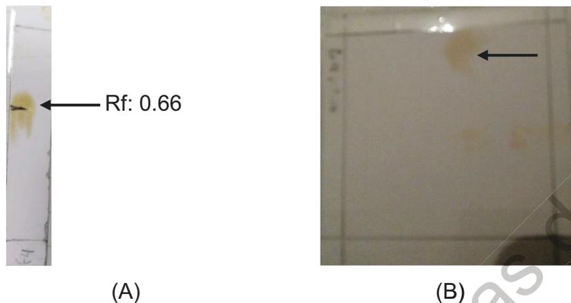
Figura 5. Cromatogramas en capa fina analítica de la fracción DMF-4-Y [(A): unidimensional, (B): bidimensional]. Sistema de elución: MeOH-AcOEt (1:1).
