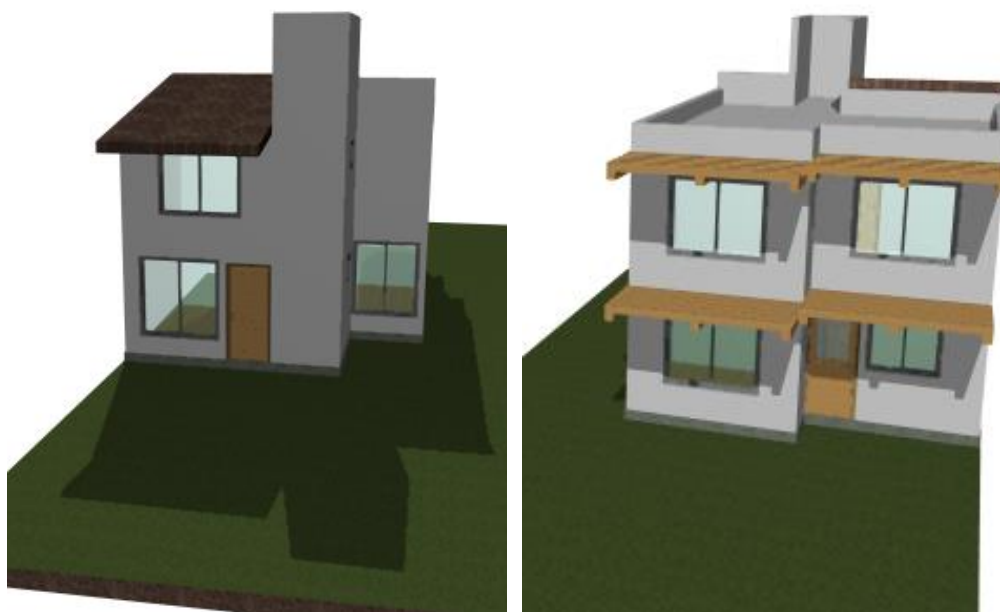
Figura XI.7 Fachada principal y fachada posterior con orientación este (diciembre 21). Imagen E.P.
