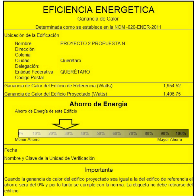
Gráfica III.39 Etiqueta obtenida del cálculo energético en el programa Sisevive Ecocasa®
