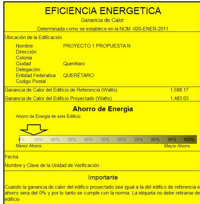
Gráfica III.15 Etiqueta obtenida del cálculo energético en el programa Sisevive Ecocasa®
