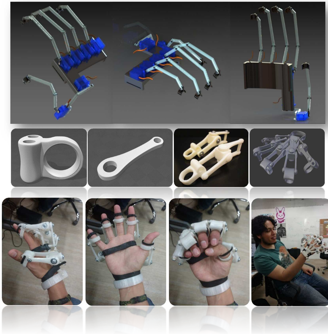
Fig. 20: Prototipado rápido de conceptos de interfaz háptica.
