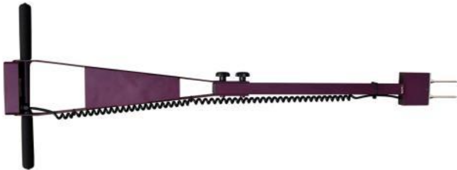
Figura 13. Sonda TDR-300 para medición de humedad en las unidades de escurrimiento de la microcuenca La Joya.
