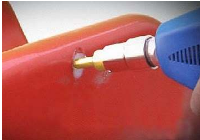
Figura 31. Soldadura por Inyección (Tecnología de los Plásticos, 2013)
