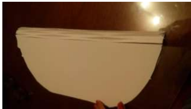
Figura 46. Modelo de corte en líneas, comprobando que el material rígido se puede doblar con dicho patrón (Fotografía propia, 2017).
