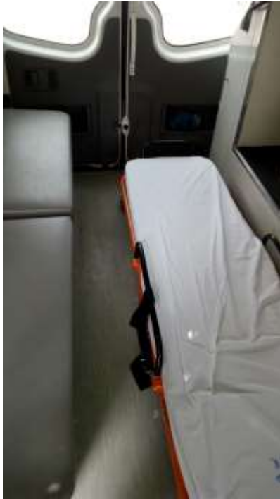
Figura 8. Diferente camilla también sin adaptación para dar RCP. No está rígida y no hay espacio designado para la tabla (Fotografía propia, 2017).
