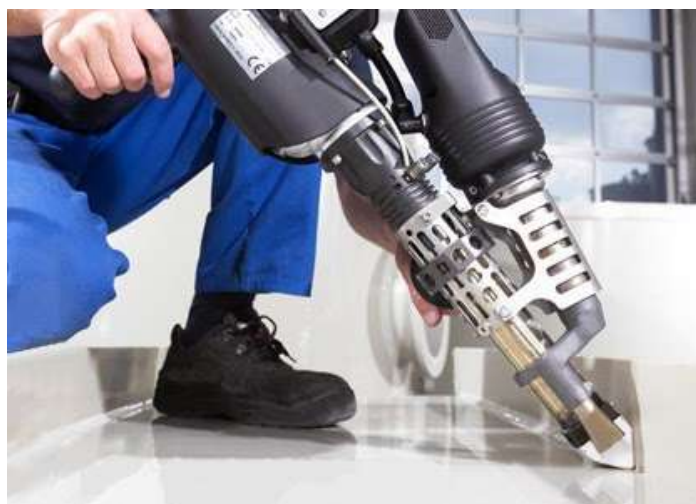
Figura 30. Soldadura por extrusión (Tecnología de los Plásticos, 2013)
