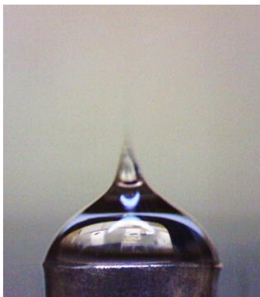
Figura 20 Formación del cono de Taylor y proyección de fibra de la muestra PEO 6 70QM303
