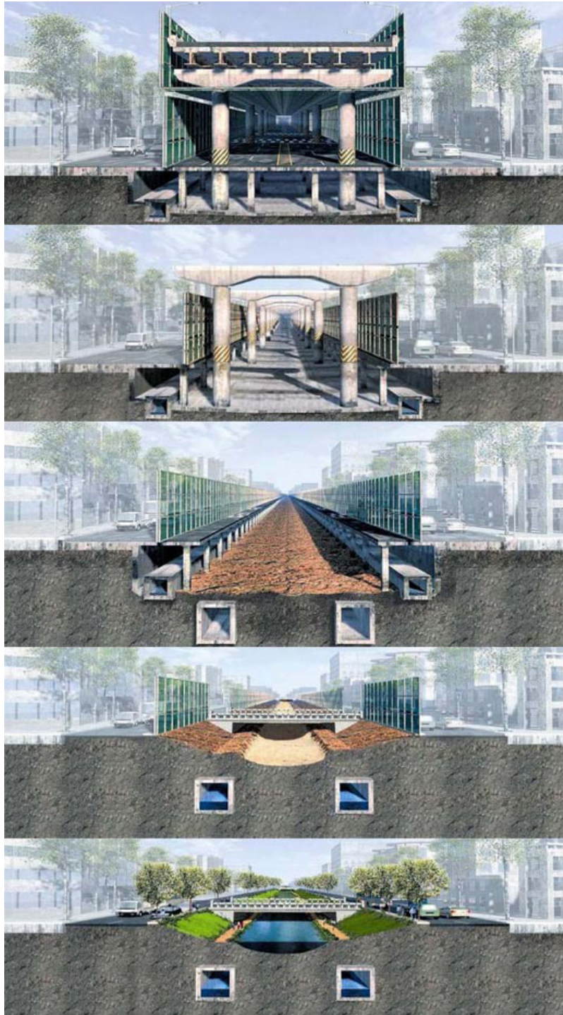
Imagen 14: Esquema del proceso de desmontaje de la autopista hasta la recuperación del río. Fuente: urban-networks.blogspot.com
