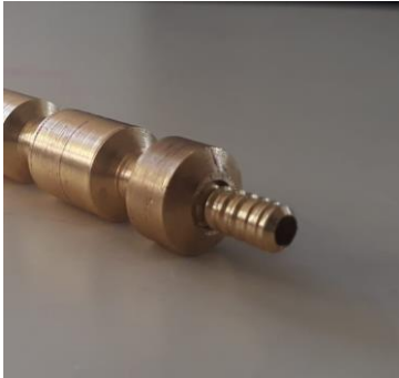
Ilustración 19 Detalle. Espiga de conexión (Elaboración propia 2018).
