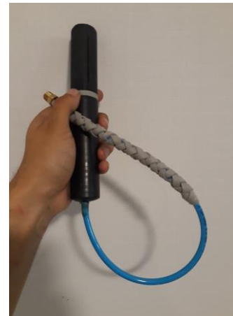
Ilustración 27 prueba de recubrimiento trenzado de espuma EVA, (elaboración propia 2018)
