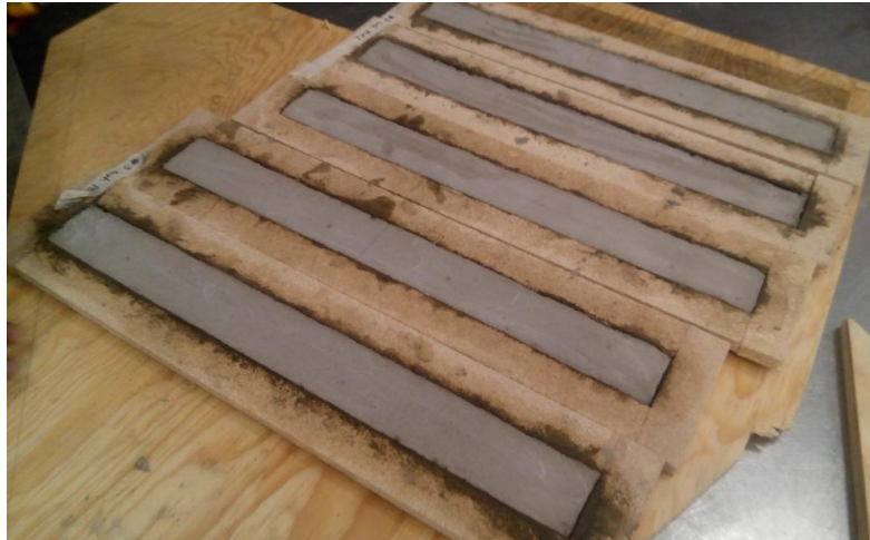
Figura 4.14. Probetas para ensayo a esfuerzos de módulo de ruptura
