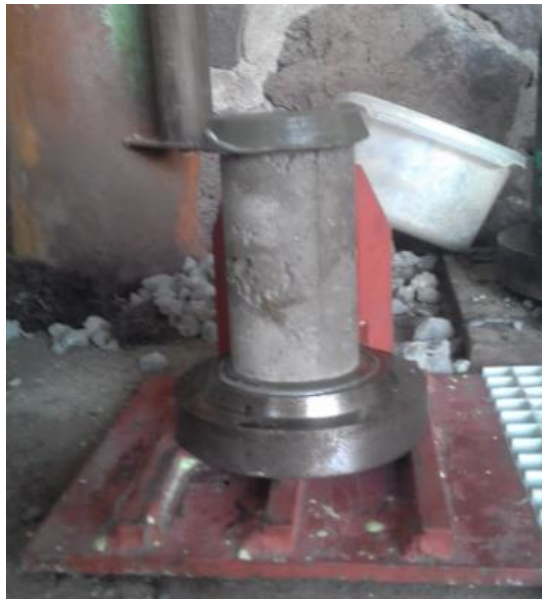
Figura 4.12. Cabeceo de cilindros para ensaye a compresión
