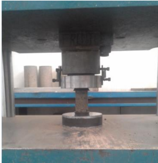
Figura 4.13. Ensayo de cilindros a compresión en maquina universal Tinius Olsen con capacidad de 300 KN
