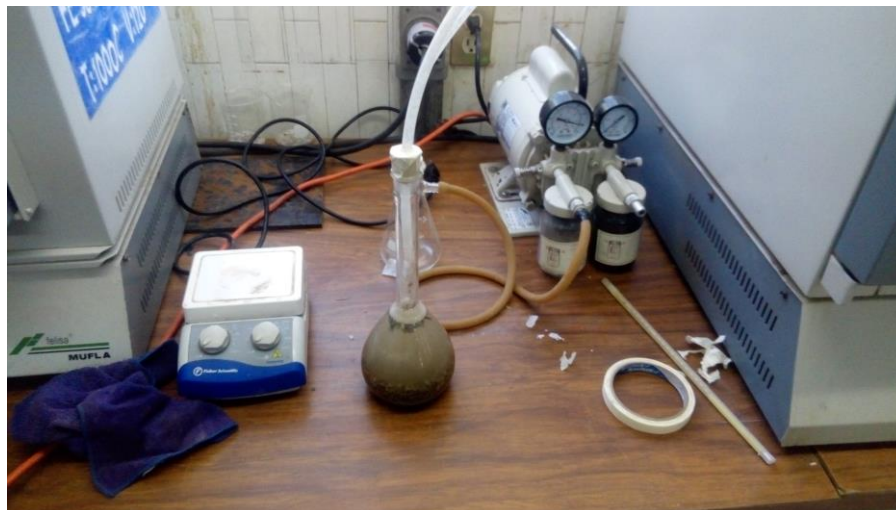
Figura 4.5. Arreglo para determinar la densidad de la arena de acuerdo a NMX-C- 165 –ONNCCE-2004
