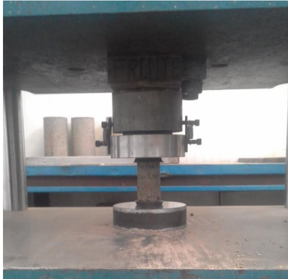
Figura 5.1 Ensayo de probetas a esfuerzos de compresion
