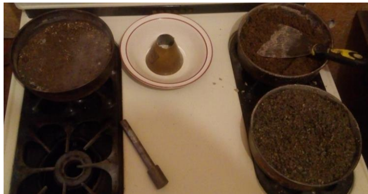
Figura 4.4 Material en condición S.S.S. para prueba de absorción y densidad NMX-C-165-ONNCCE-2004
