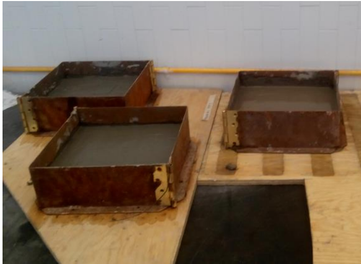
Figura 4.16. Construcción de probetas de ensaye por conductividad térmica.
