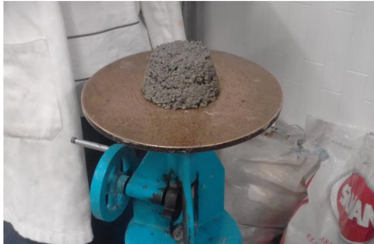
Figura 4.10. Determinación de fluidez empleando la mesa de fluidez con 25 golpes en 15 segundos
