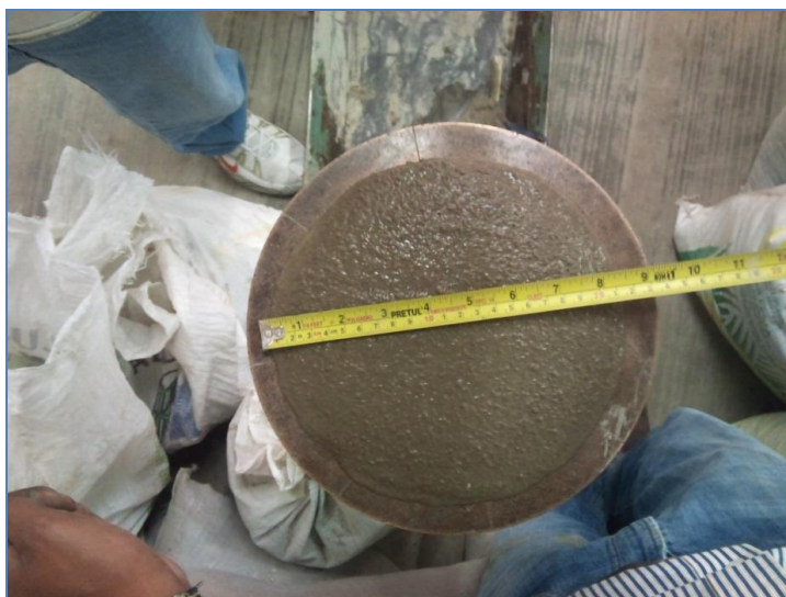
Figura 4.11. Medición de cuatro diámetros para determinar la fluidez del mortero
