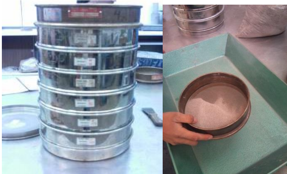
Figura 4.3. Tamices para prueba de granulometría de la arena según norma ASTM C136-01
