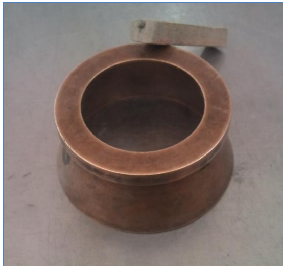
Figura 4.9. Molde tronco-cono para la determinación de la fluidez de morteros
