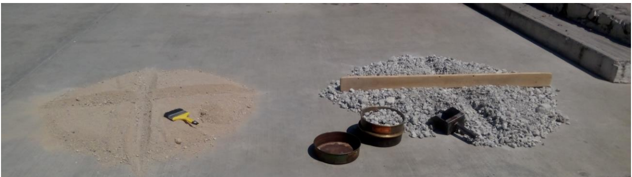
Figura 4.2. Cuarteo representativo de muestras arena y pomacita para pruebas preliminares
