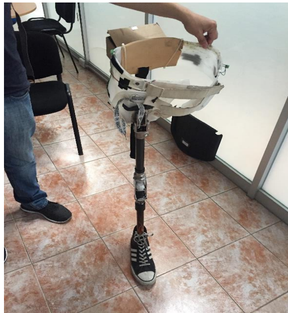
Figura 6 Sistema de sensores añadido al encaje, elaboración propia
