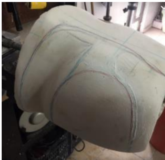
Figura 16 Diseño de encaje sobre molde, elaboración propia
