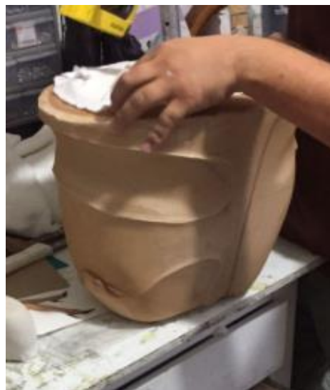
Figura 18 Proceso de colocación de textil en molde, elaboración propia
