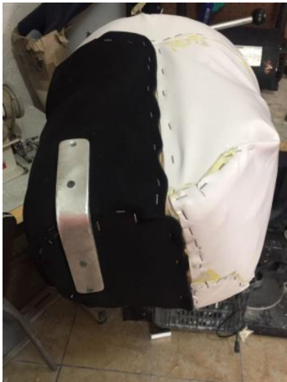
Figura 20 Placa de aluminio colocada en el molde, elaboración propia
