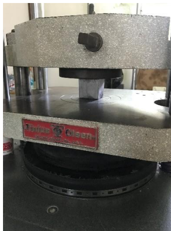
Figura 20. Probeta colocada en la maquina universal antes de ser sometida a carga. Fuente propia.
