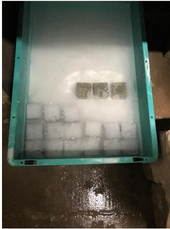
Figura 18. Probetas utilizadas en pruebas preliminares totalmente sumergidas en agua. Fuente propia.
