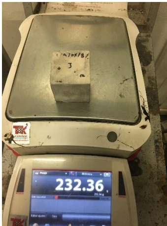
Figura 19. Pesado de probetas utilizadas en pruebas preliminares después de haber sido sumergidas en agua durante 24 horas. Fuente propia.
