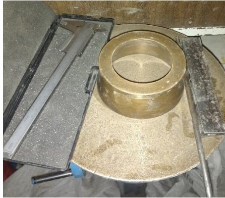
Figura 23. Equipo utilizado para la prueba de fluidez. Fuente propia.
