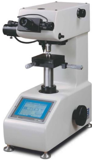
Figura 40. Durómetro marca LECO, serie LM 700-AT con aumento en objetivos de 500X y 100X.
