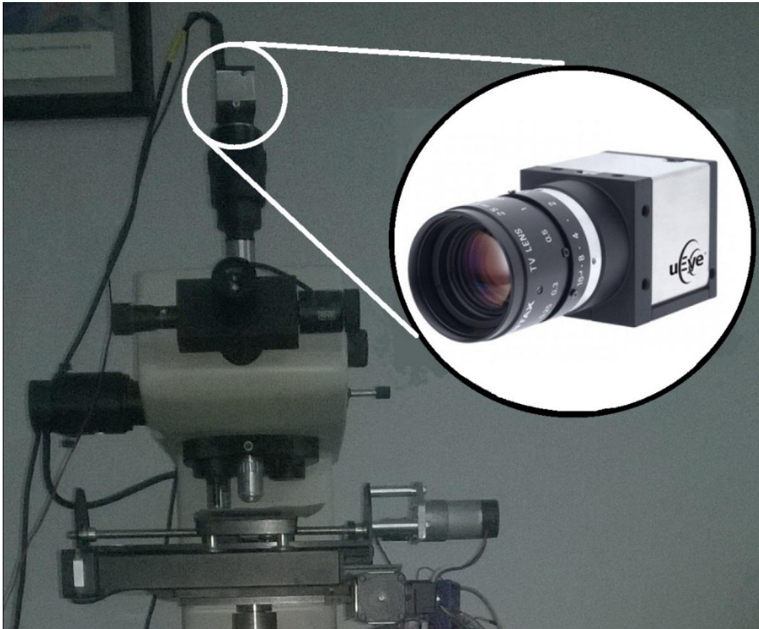
Figura 44. Cámara de video uEye montada sobre el ocular superior del durómetro.
