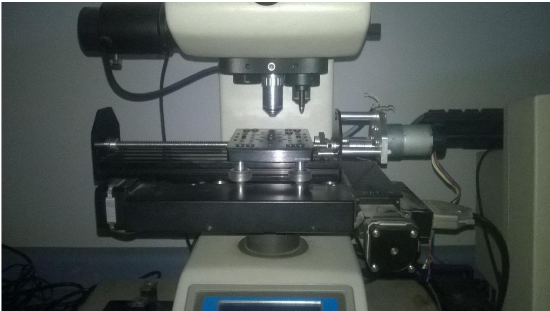
Figura 41. Durómetro con actuador lineal ya integrado en su área de trabajo.
