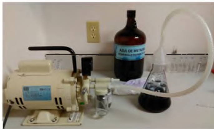
Figura 9. Bomba conectada al matraz en el que se efectúa la prueba de hermeticidad con azul de metileno (Fuente propia, 2017).
