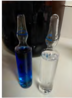
Figura 10. Ampolleta sin sellar herméticamente se llena de la solución de azul de metileno, mientras que una ampolleta cerrada herméticamente una vez que se ha limpiado se mantiene como al inicio de la prueba (Fuente propia, 2017).
