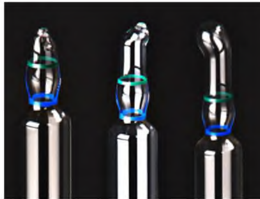
Figura 7. Ampollitas deformes (Fuente propia, 2016).
