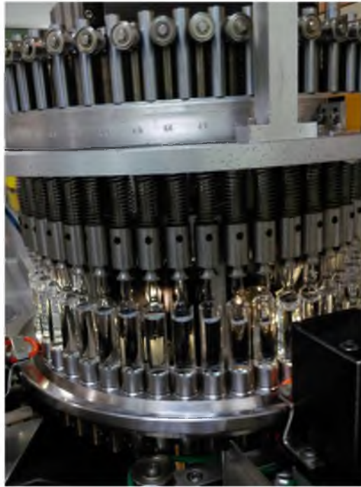
Figura 11. Revisadora de ampolletas (Fuente propia, 2017).
