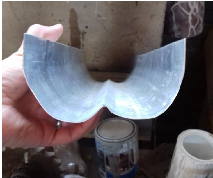
Figura 7.8. Construcción de canales de CPC.
