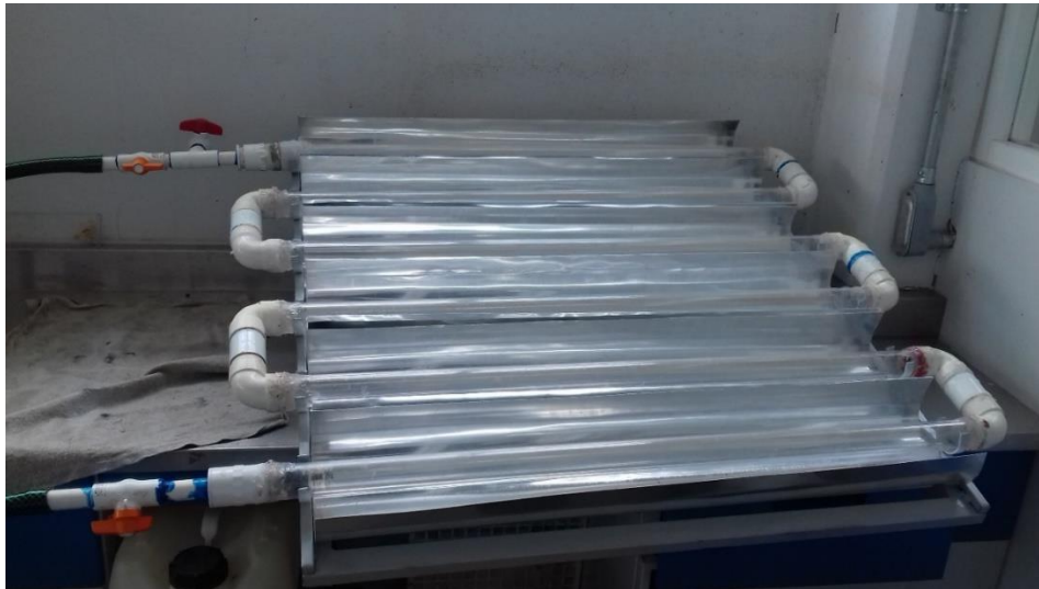
Figura 7.10. CPC con los tubos de acrílico montados
