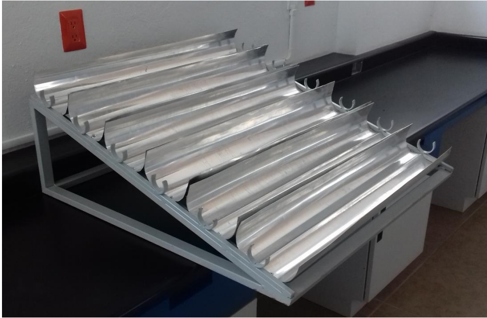
Figura 7.9. CPC construido y montado en soporte a 20°.
