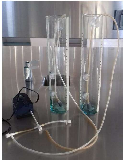
Figura 6.1. Reactores para medición de la biodegradabilidad del benceno.
