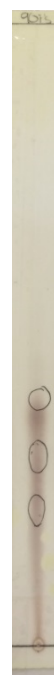
Figura 9. Perfil cromatográfico en capa fina de la fracción “F90”. Fase estacionaria: gel de Sílice, MeOH:CH 3 CN (50:50).
