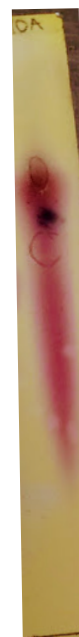
Figura 10. Perfil cromatográfico en capa fina de la fracción “F90A”. Fase estacionaria: Silica gel 60, C-18 F 254 , Fase móvil: MeOH:CH 3 CN 95:5.
