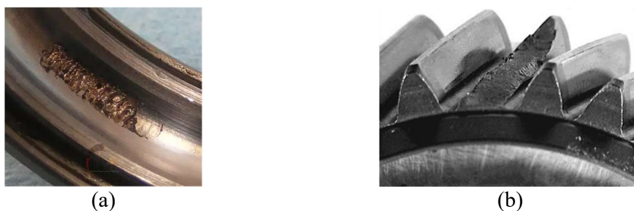
Figura 3. Fallas clásicas estudiadas. (a) Pista interna de rodamiento dañada (Bediaga et al., 2013). (b) Fractura en diente de engrane (Ebrahimi et al., 2013).
