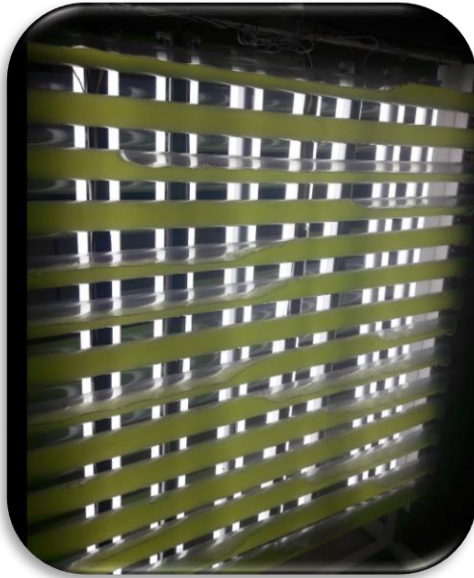
Ilustración 2 Fotobiorreactor tubular cerrado de 60L.
