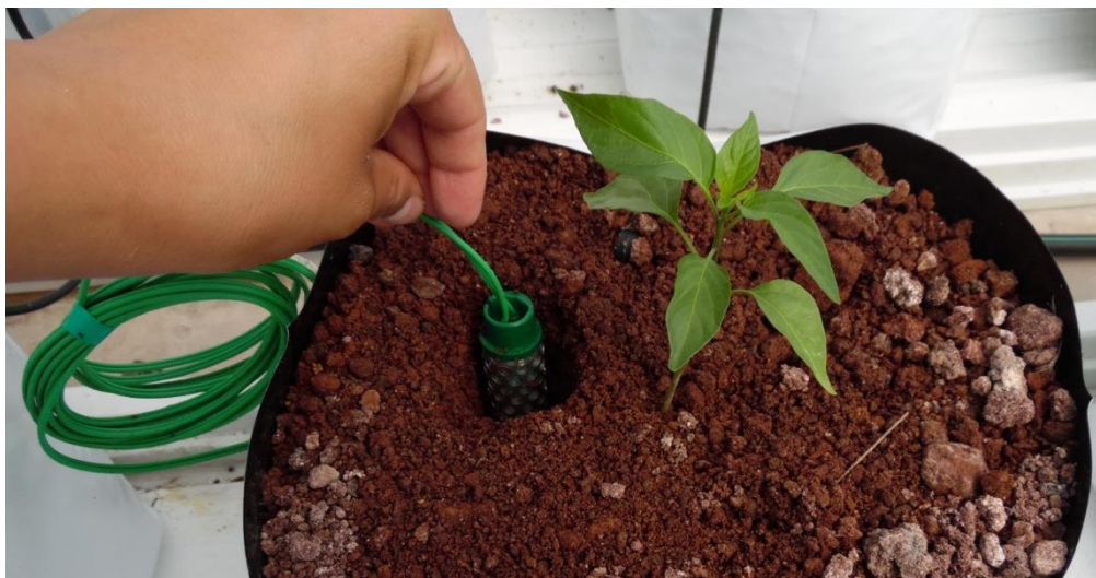
Figura 10. Colocación del sensor de humedad en suelo WATERMARK modelo 200SS.
