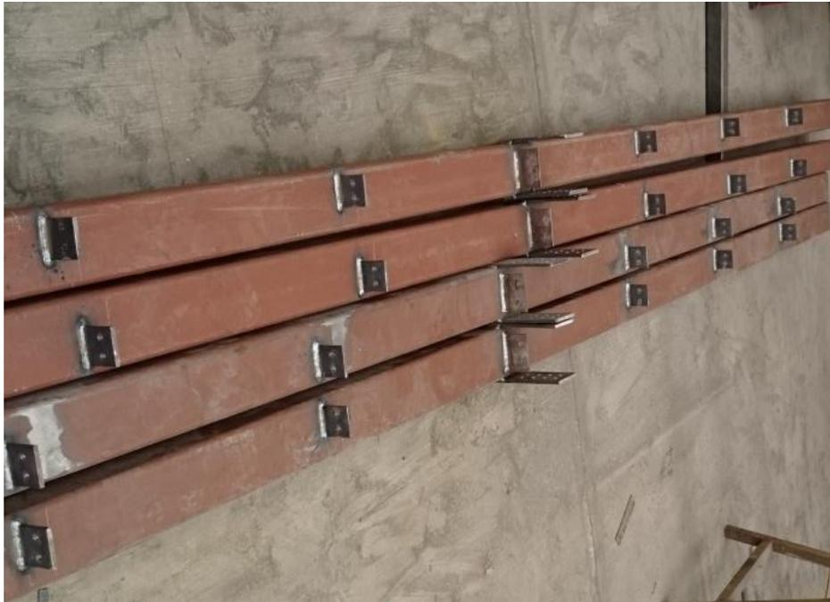
*Figura 5-5. Prototipo de conexión simple o de cortante C4 y conexión a momento viga secundaria-viga principal C3.*
