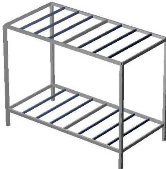
*Figura 4-2. Módulo de la estructura propuesta a base de perfiles PTR A 500 GR. B y Montén 3 MT 14.*
