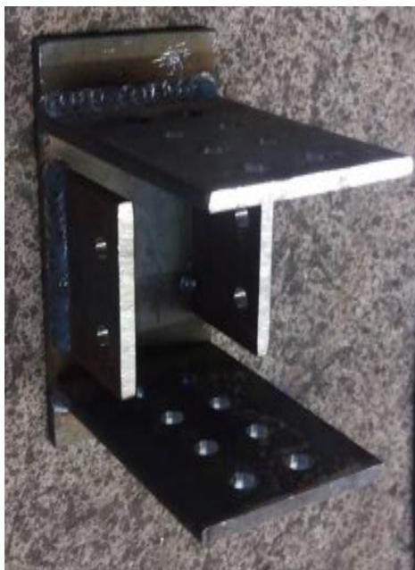
*Figura 5-2. Prototipo de conexión a momento C2 viga-columna con placa de respaldo.*
