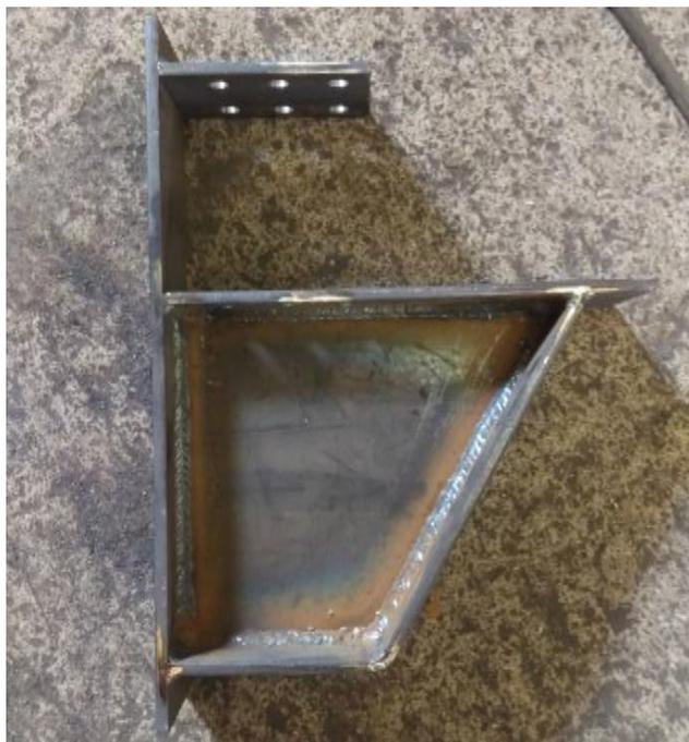
*Figura 5-1. Prototipo de conexión rígida C1 viga-columna con placa de respaldo.*
