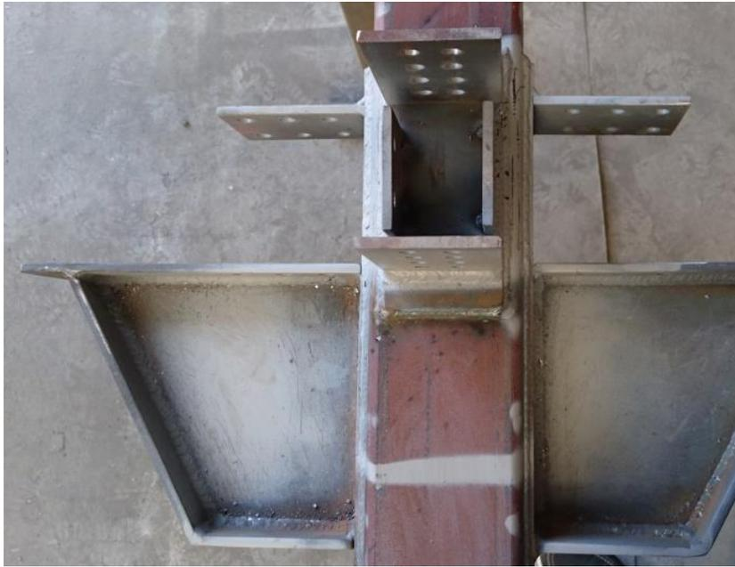
*Figura 5-3. Conexiones C1 y C2 unidas a un segmento de columna.*
