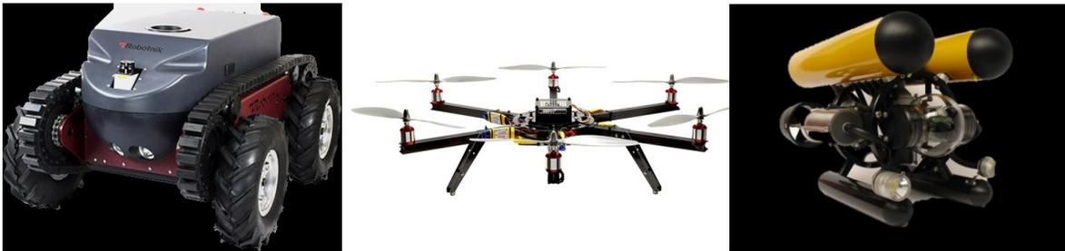
**Figura 4. Tipos de Robots Móviles a) Robot Terrestre con Ruedas b) Robot Aéreo no Tripulado c) Robot Subacuático**
