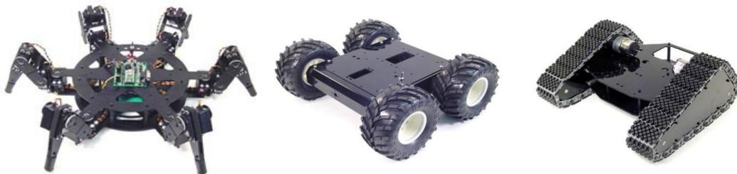
**Figura 5. Locomoción de robots móviles: a) Patas, b) Ruedas, c) Orugas**
