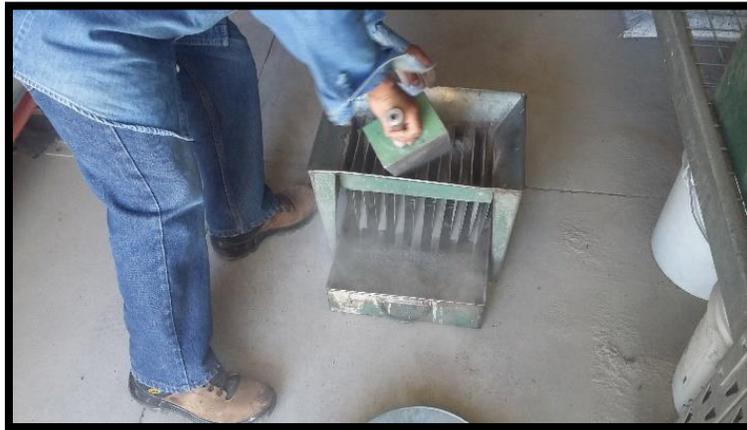
**Figura 3-5. Equipo cuarteador mecánico.**
