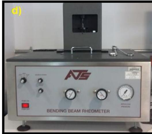
**Figura 3-16. Reómetro de viga a flexión (BBR).**
