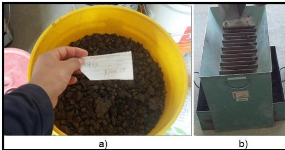
**Figura 3-3. Procesamiento del RAP. a) Almacenamiento del RAP muestreado. b) Cuarteador mecánico para la reducción de muestras de RAP.**
