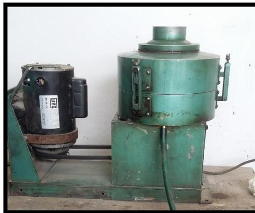
**Figura 3-4. Equipo Rotarex para la extracción centrífuga del cemento asfáltico proveniente del RAP.**
