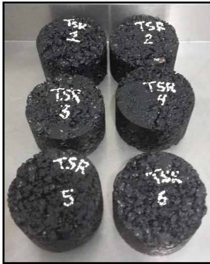
**Figura 4-19. Probetas para la ejecución de la prueba de susceptibilidad al daño inducido por humedad. Mezcla de referencia.**
