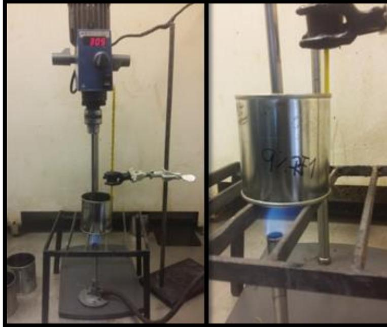
**Figura 3-22. Incorporación de aditivo rejuvenecedor para producir los asfaltos de aporte.**
