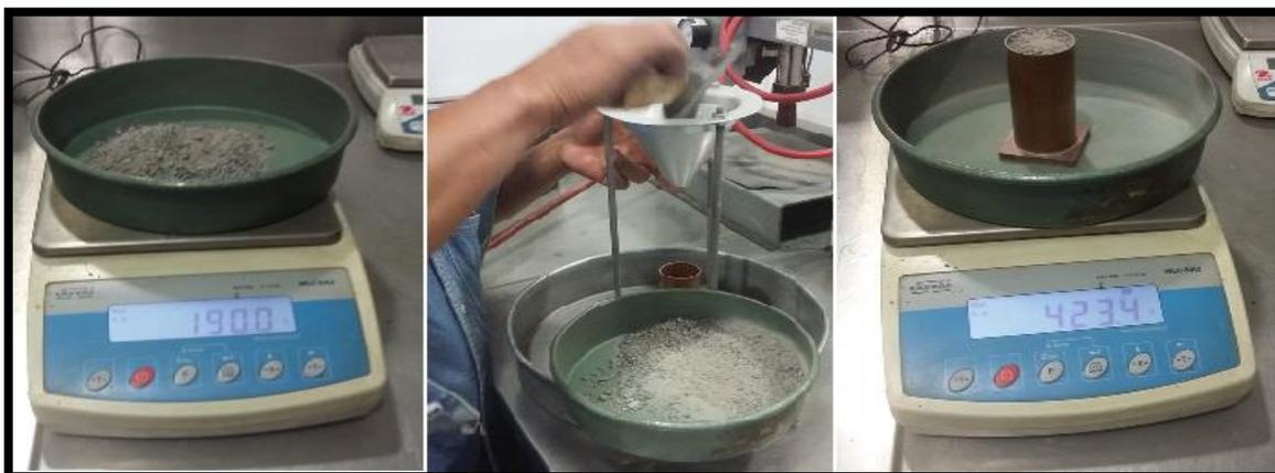
Figura 7-8. Realización de prueba: Angularidad de agregado fino.
