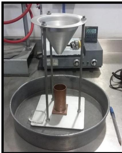
**Figura 3-11. Equipo de Angularidad para agregado fino.**
