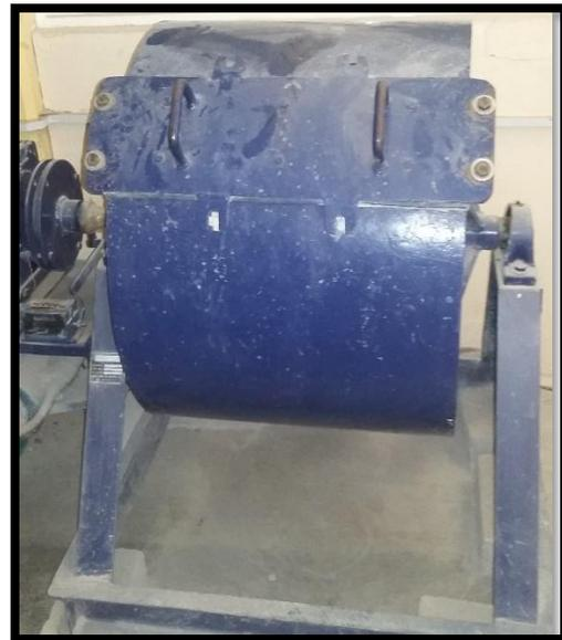
**Figura 3-7. Máquina de desgaste de los Ángeles.**
