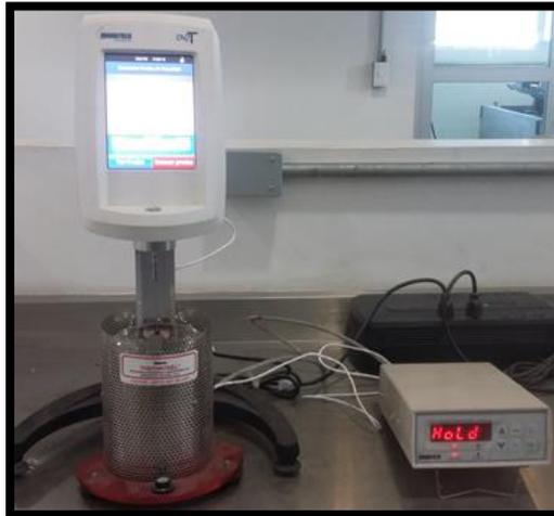
**Figura 3-19. Viscosímetro Rotacional Brookfield.**
