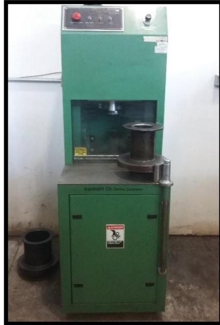
Figura 3-24. Equipo Compactador Giratorio Superpave marca Rainhart.
