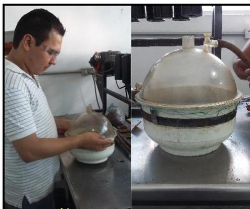
**Figura 4-11. Realización del ensayo para determinar la Gravedad Teórica Máxima.**
