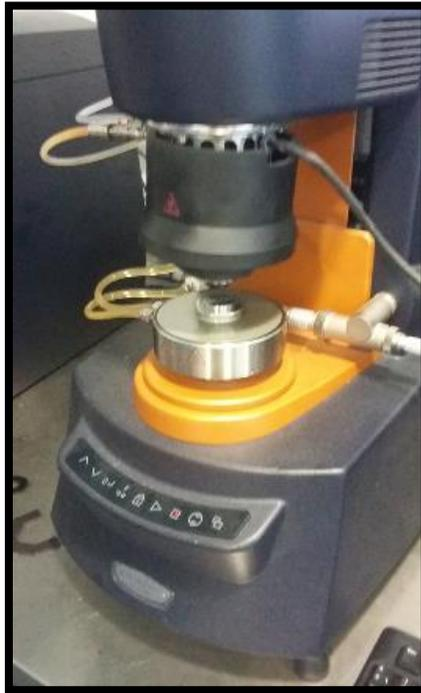
**Figura 3-15. Reómetro de Corte Dinámico (DSR) para la determinación de las propiedades visco-elásticas lineales de los aglutinantes asfálticos.**
