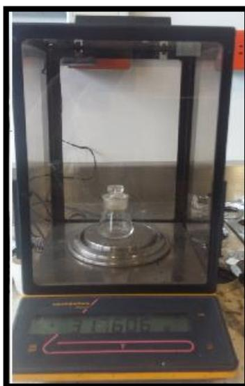
**Figura 3-18. Equipo para determinar la densidad del asfalto.**
