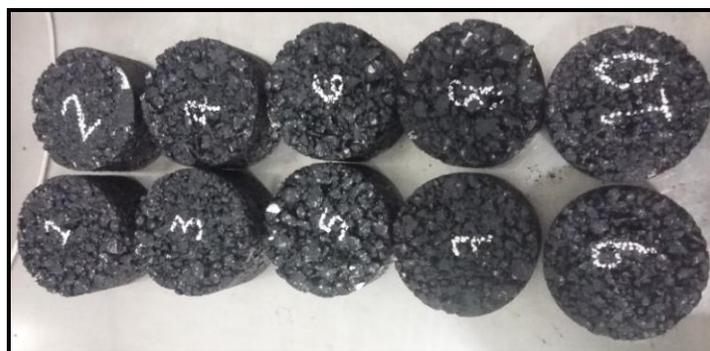
**Figura 4-13. Probetas del diseño experimental para la mezcla de referencia. Probetas de 100mm de diámetro y 63,5 mm de altura aproximadamente.**
