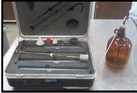
**Figura 3-9. Equipo para la prueba de Equivalente de Arena.**
