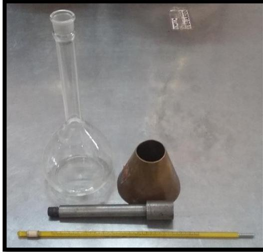
**Figura 3-13. Equipo para la determinación de la Gravedad Específica (Densidad) de los agregados finos.**
