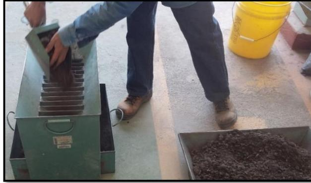
**Figura 4-2. Reducción de muestra de RAP a tamaño de ensayo.**
