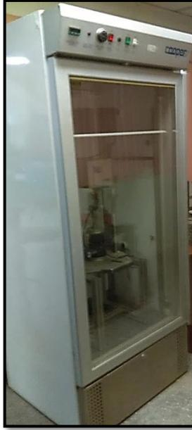
**Figura 3-31. Equipo Servo-neumático marca Cooper, para la realización de ensayos dinámicos.**
