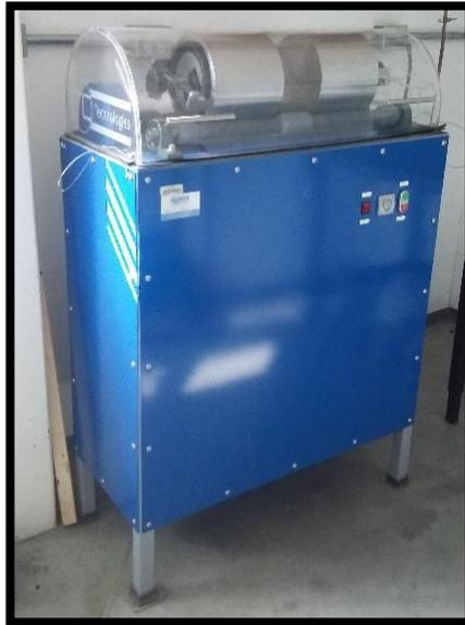
**Figura 3-8. "Máquina Micro-Deval" para abrasión de los agregados gruesos.**
