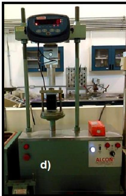
**Figura 3-27. Prensa y Mordaza Lottman para ensayo de TSR.**
