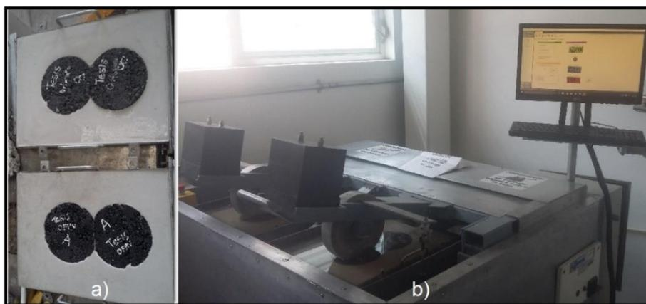
**Figura 4-24. Preparación y montaje de probetas para el ensayo de deformación permanente por rodera. Mezcla de referencia.**
