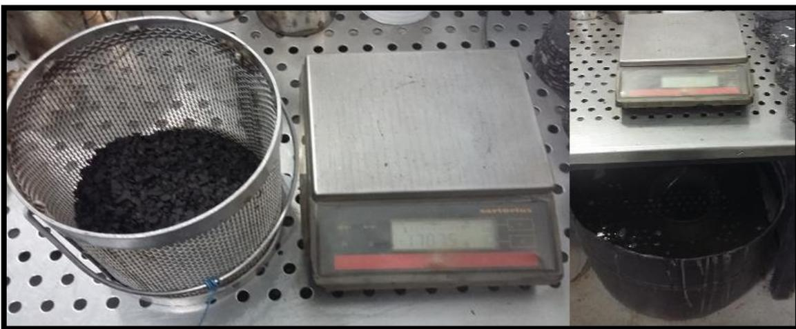
Figura 7-5. Realización de prueba: Gravedad Específica y Absorción de agregado grueso.
