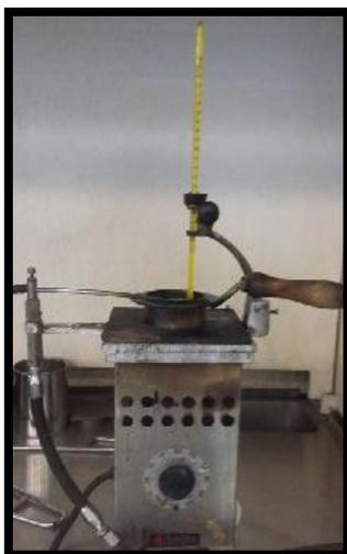
**Figura 3-17. Equipo aplicador de flama para la determinación del punto de inflamación.**
