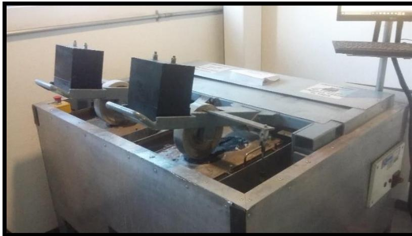
**Figura 3-28. Equipo Rueda Carga de Hamburgo. Equipo propiedad de Lasfalto.**
