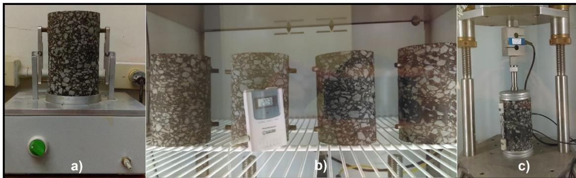
**Figura 3-30. a) Colocación de pines; b) acondicionamiento de especímenes a temperatura de ensayo, c) colocación de LVDT's y espécimen bajo el pistón de la prensa dinámica.**
