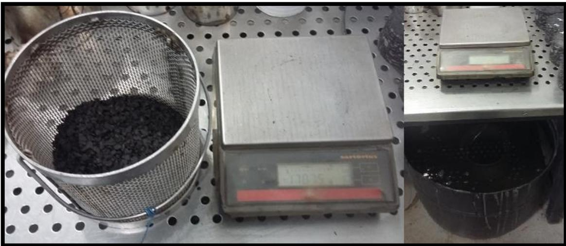
**Figura 3-12. Equipo para la determinación de la Gravedad Específica (Densidad) de los agregados gruesos.**
