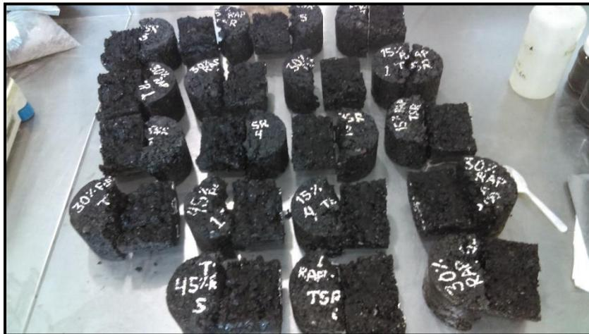
**Figura 4-23. No existe rotura de agregados, por lo que se deduce que la falla en las probetas fue debido a que se superó el límite de fluencia de la mezcla asfáltica.**
