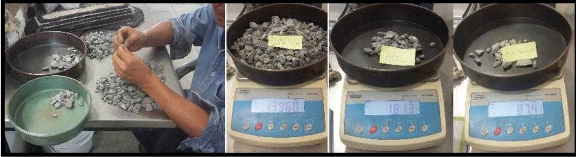
Figura 7-4. Realización del ensayo Caras Fracturadas.
