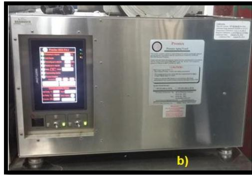
Figura 3-21. Horno PAV.
