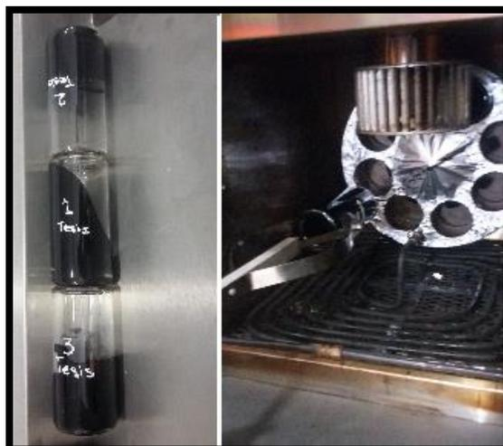
Figura 7-10. Realización de prueba: Pérdida en masa después de envejecimiento en RTFO.
