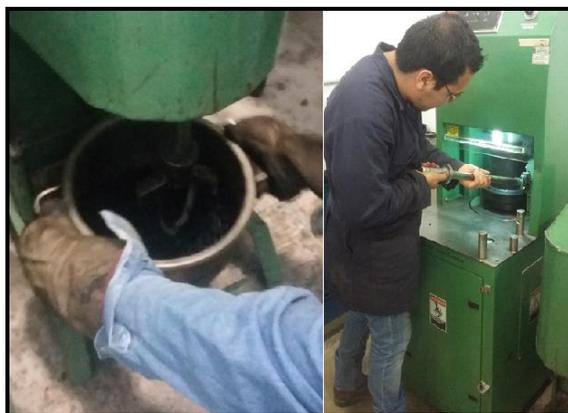
**Figura 4-12. Mezclado y elaboración de probetas para la determinación de la Gravedad Bruta compacta mediante el Compactador Giratorio Superpave.**
