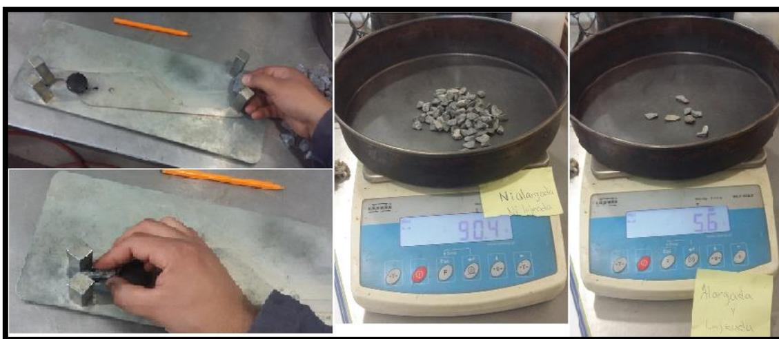
**Figura 7-3. Realización del ensayo Forma de Partícula.**
