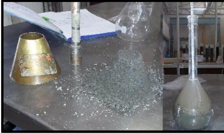
Figura 7-7. Realización de prueba: Gravedad Específica y Absorción de agregado fino.
