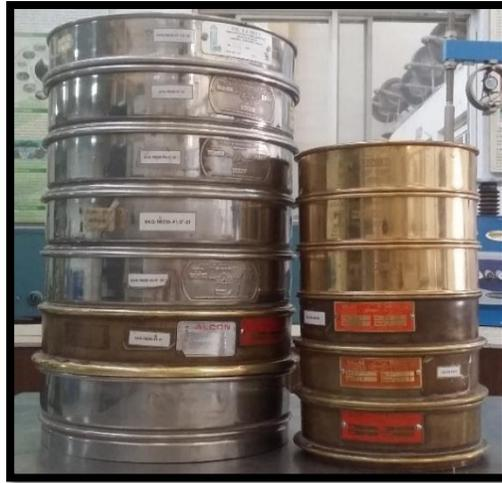
**Figura 3-6. Mallas para granulometría, a la izquierda se encuentran las mallas para gravas y a la derecha las mallas para arenas.**
