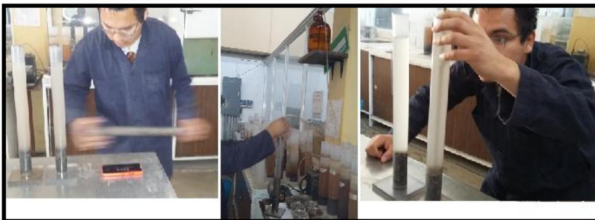
**Figura 7-6. Realización de prueba: Equivalente de Arena de agregado fino.**
