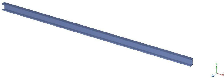
Figura 6-19 Elementos crítico rolado en frio tipo monten de propuesta a base de panel doble para revisión por estado limite de servicio "Deflexión"
