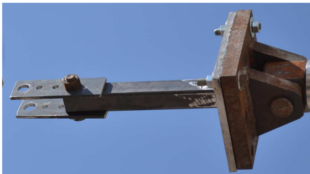
Figura 5-19 Estructura auxiliar para fijación de carga aplica en prototipo de prueba.
