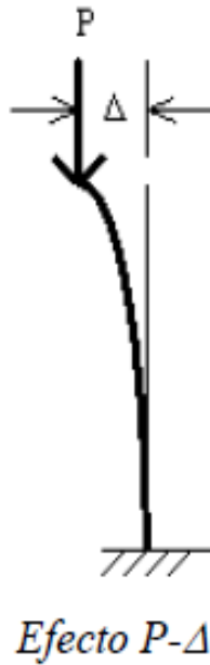
Figura 5-10 Esquema representativo del efecto P-Delta producido en un elemento estructural.
