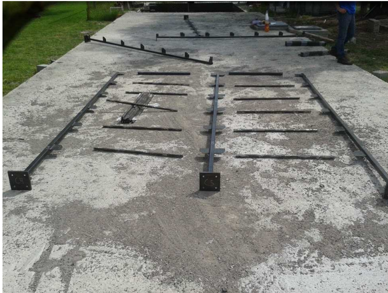
Figura 6-15 Presentación de espécimen de prueba in situ para su armado por medio de atornillamiento de sus componentes.
