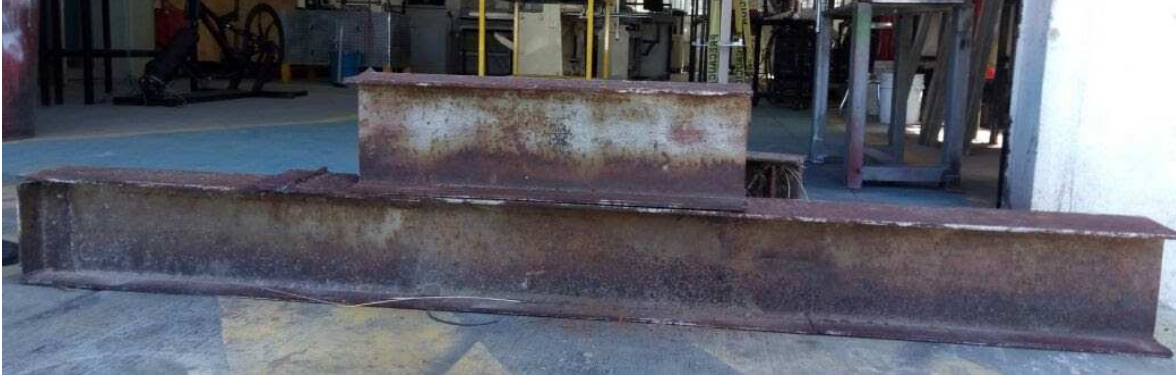
Figura 5-36 Representación de cargas de servicio idealizadas mediante el uso de un perfil estructural de peso equivalente.
