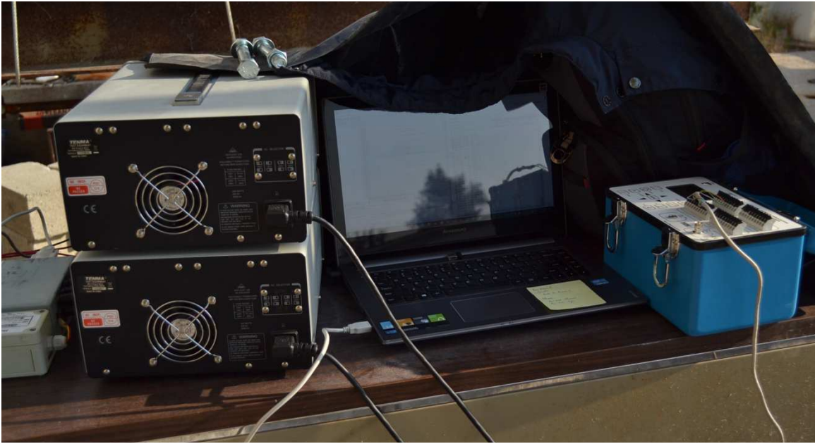
Figura 5-20 Instrumentación complementaria para la medición y recolección de carga aplicada y desplazamientos..
