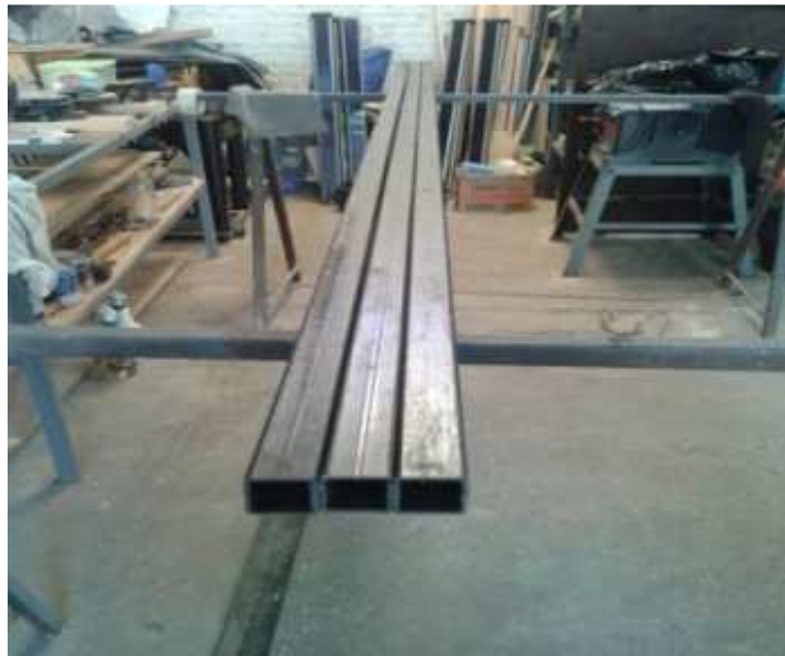
Figura 6-8 Proceso de maquilado de elementos verticales (columnas) de sistema de estructuración a base de panel simple.
