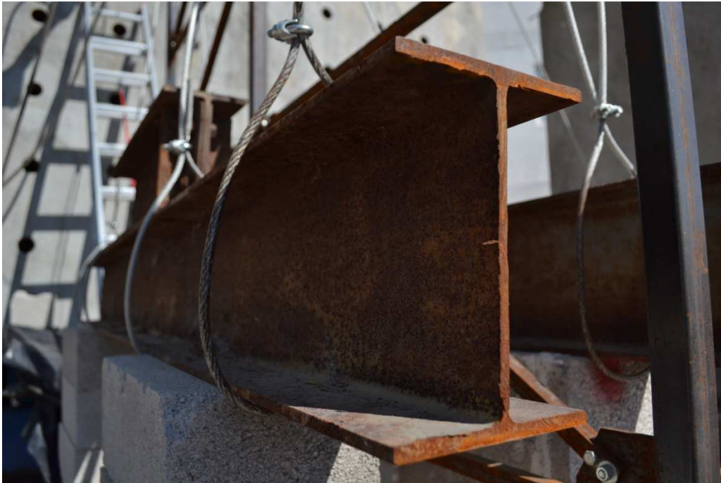
Figura 5-38 Cargas de servicio impuestas en sistema de estructuración mediante el uso de cables de acero.
