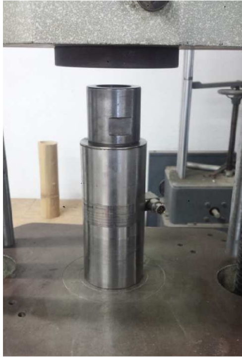
Figura 5-14 Instrumentación de carga (celda de carga) para medición de magnitud de carga aplicada.
