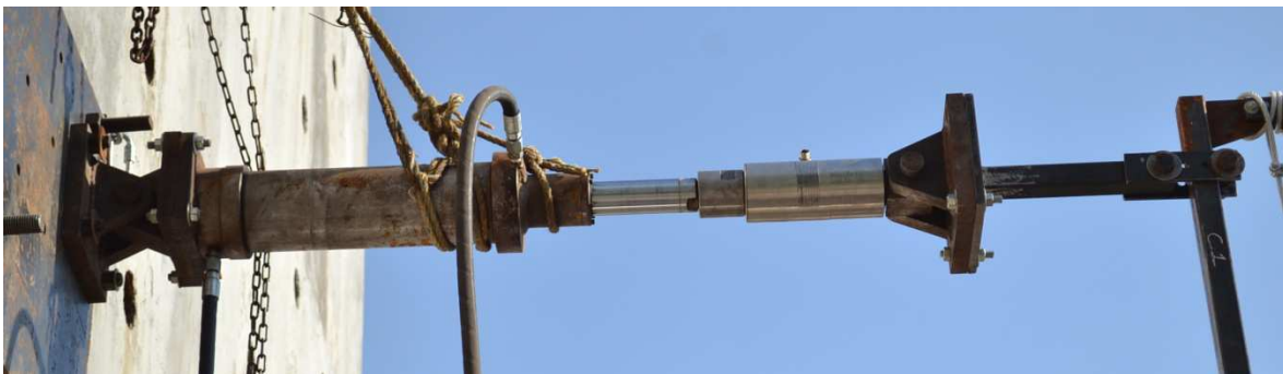
Figura 5-35 Representación de carga lateral mediante la implementación de un cilindro hidráulico.
