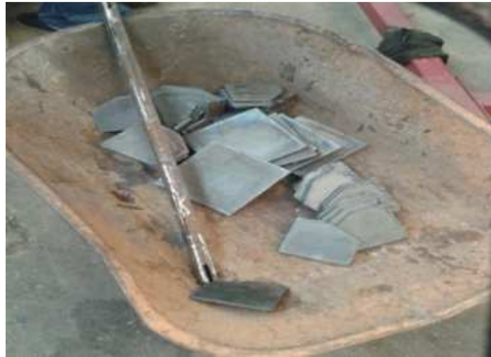
Figura 6-7 Proceso de maquilado de placas de unión y placas base en ambiente controlado "taller".
