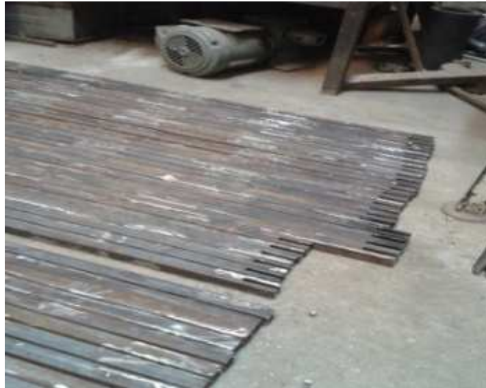
Figura 6-9 Proceso de maquilado de elementos de arriostramiento (horizontales y diagonales) de propuesta a base de panel simple.
