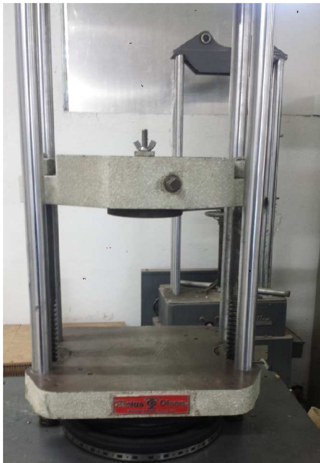
Figura 5-18 Instrumentación para calibración de celda de carga (prensa hidráulica).
