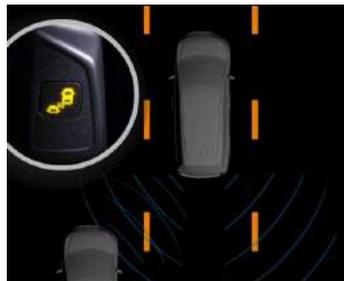
**Figura 2.5:** Activación de BLIS en una camioneta Odyssey 2011 de Toyota, imagen tomada del vídeo explicativo del sistema proporcionado por la marca en su sitio oficial (American Honda Motor, 2017).
