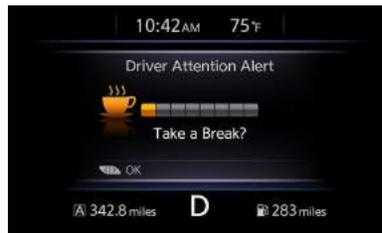
**Figura 2.9:** Ejemplo de alerta visual desplegada por el sistema de detección de fatiga ofrecido por Nissan (Nissan, 2017).
