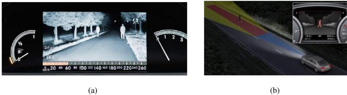
**Figura 2.8:** A la izquierda, (a) representación gráfica del NVA de Mercedes-Benz basado en cámaras infrarrojas (Daimler AG., 2016c); a la derecha, tomada de (Audi AG, 2016), (b) imagen ilustrativa sobre el funcionamiento del NVA implementado por AUDI utilizando cámaras termográficas.
