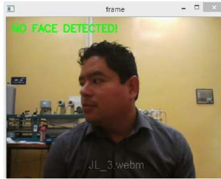
**Figura 5.2:** Muestra de la indicación visual desplegada si el sistema no detecta el rostro del usuario.
