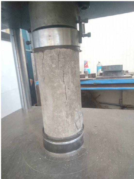
Fig 4.8. Falla de especímenes que no fueron expuestos a ciclos de humedecimiento y secado
