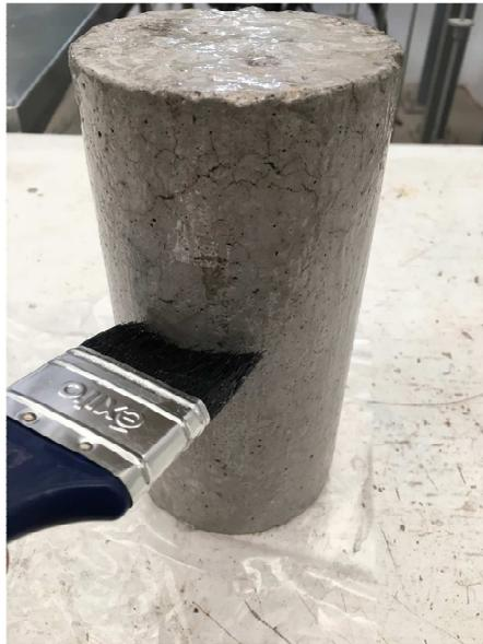
Figura 4.2 Aplicación de recubrimiento
