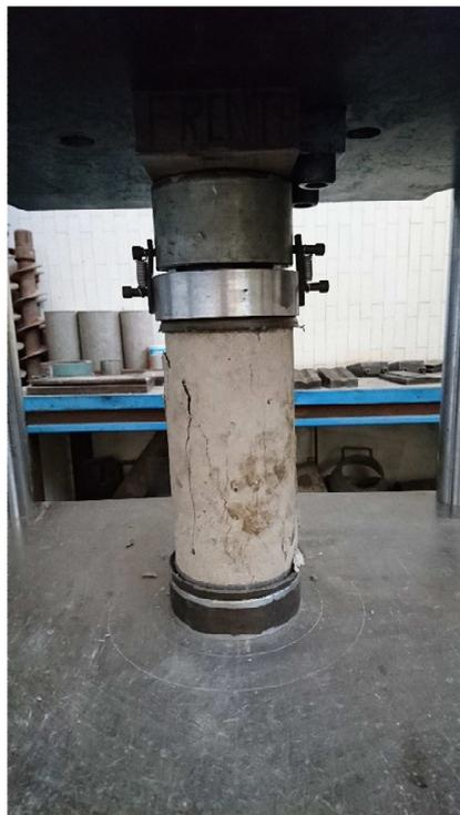
Fig. 4.5 Evaluación de resistencia a la compresión
