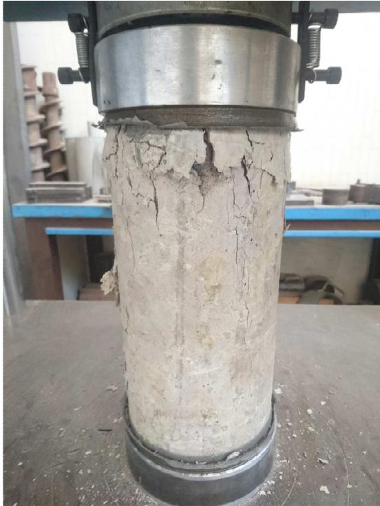
Fig. 4.7. Falla de especímenes expuestos a ciclos de humedecimiento y secado
