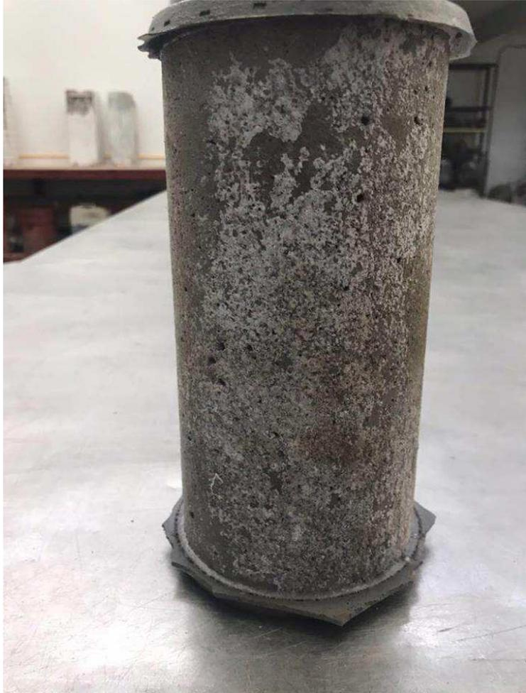
Figura 4.11 Ataque de sulfatos en especímenes de concreto
