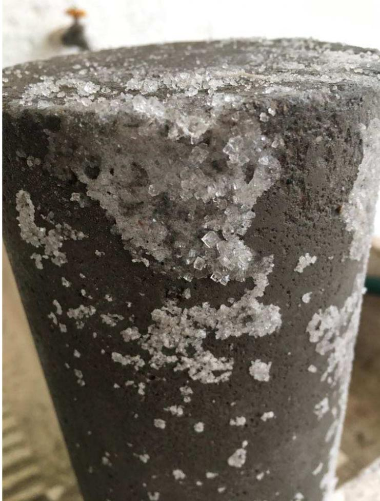
Figura 4.17 Espécimen a 80 días de ciclos de humedecimiento y secado.
