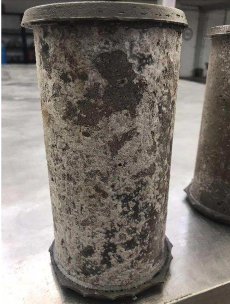
Figura 4.12 Pérdida de recubrimiento en especímenes.
