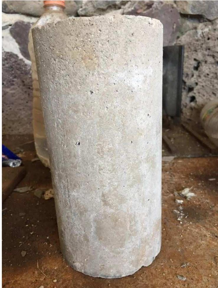
Figura 4.15 Espécimen a 40 días de ciclos de humedecimiento y secado.
