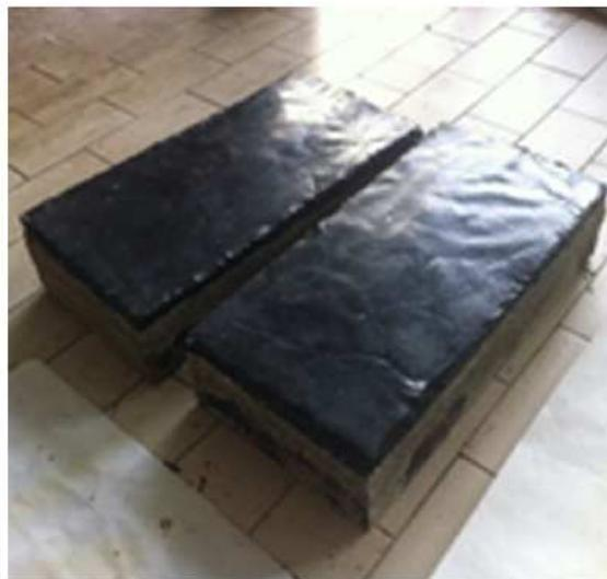
Fig. 2.2 Membrana a prueba de agua colocada en las caras del concreto,
