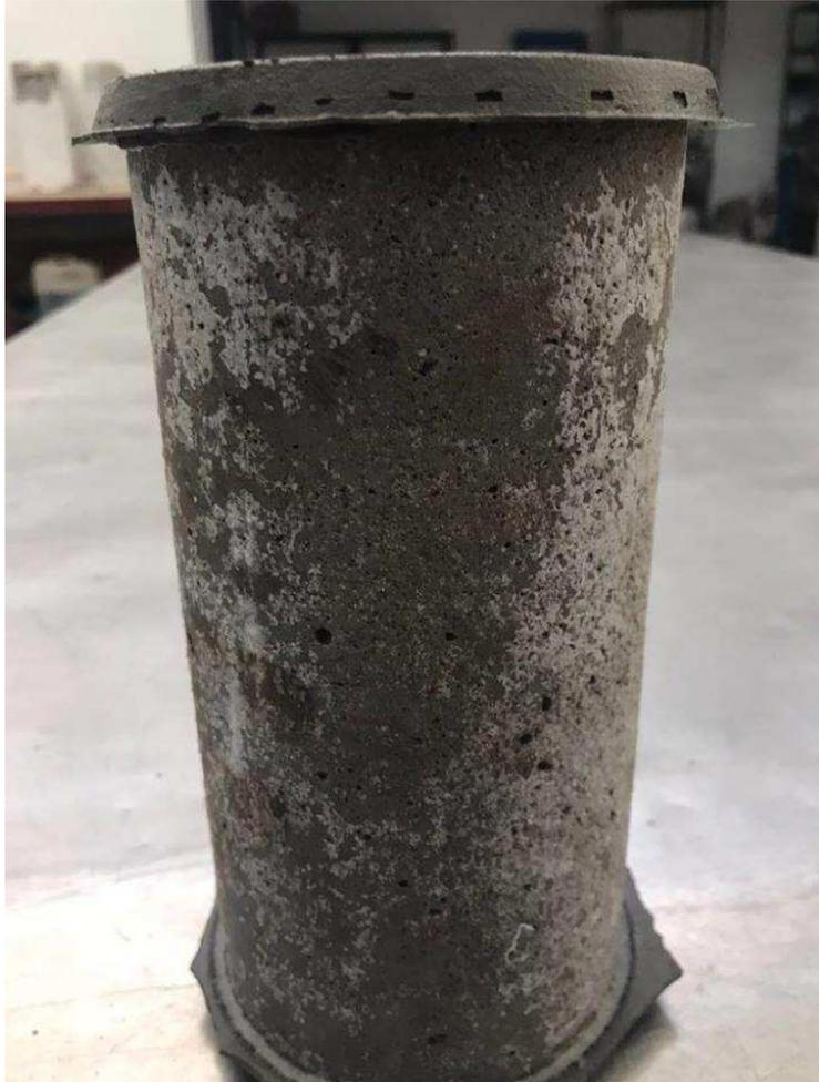
Figura 4.16 Espécimen a 60 días de ciclos de humedecimiento y secado.
