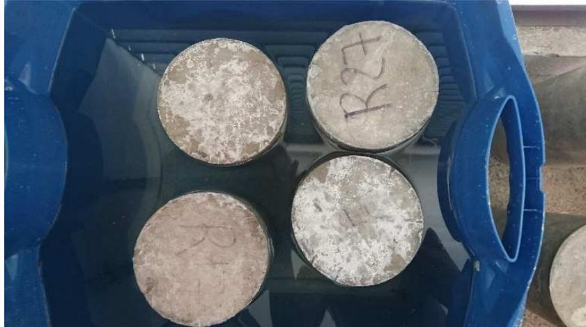
Fig. 4.4. Ciclos de humedecimiento y secado
