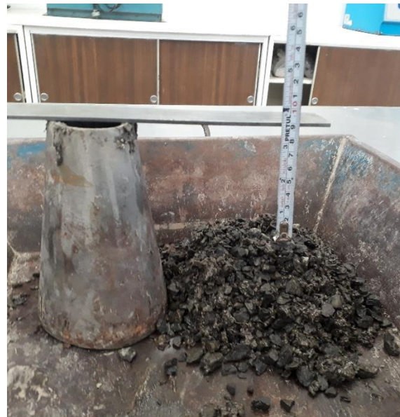
Figura 47. Medición del revenimiento a mezcla de concreto base PL (Fuente propia).
