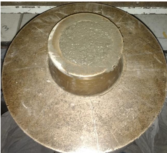
Figura 30. Masa de mortero en el cono y mesa de fluidez (Fuente propia).
