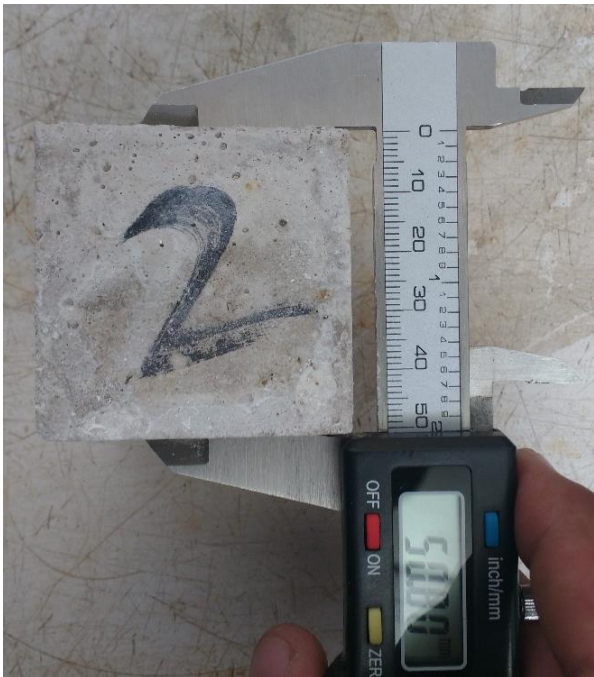
Figura 32. Medición de cubo de mortero (Fuente propia).
