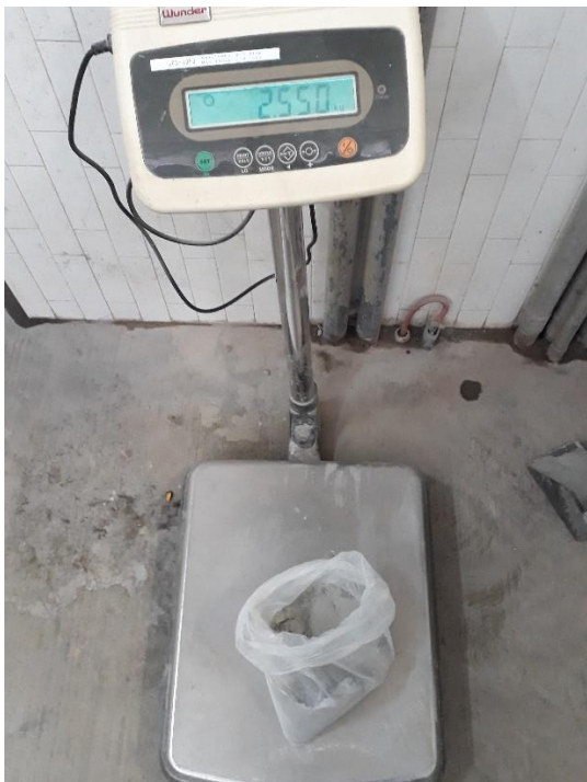
Figura 25. Pesado de cemento Portland (Fuente propia).
