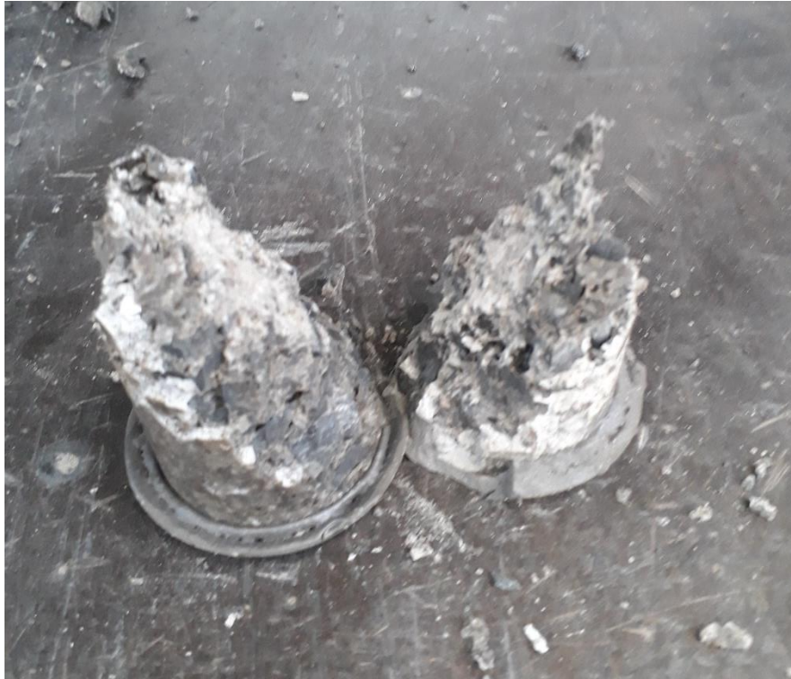
Figura 73. Falla de cilindro #10 de concreto base PL en prueba de compresión, agregado grueso (Fuente propia).
