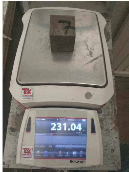
Figura 33. Pesado de cubo de mortero arena-cemento (Fuente propia).
