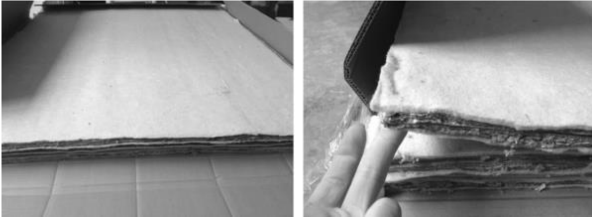
Figura 11. Estructura interna de los paneles fabricados con cartón reciclado – PE y fibras textiles. Fuente: (Ricciardi et al., 2014).
