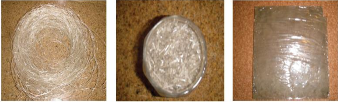
Figura 12. Poliestireno Líquido endurecido usado como sustituto de fenolita en la fabricación de tarjetas de circuitos electrónicos. Fuente: (Schmidt et al., 2011).
