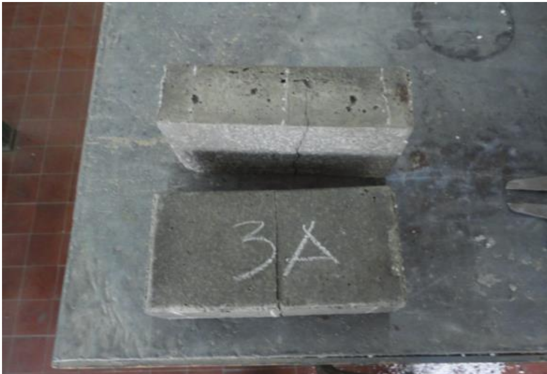
Figura 6. Grietas resultantes en el tabique después de prueba de tensión. Fuente:
