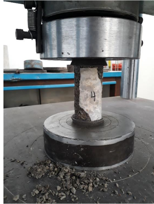
Figura 52. Prueba de compresión simple a cilindro de concreto base PL (Fuente propia).
