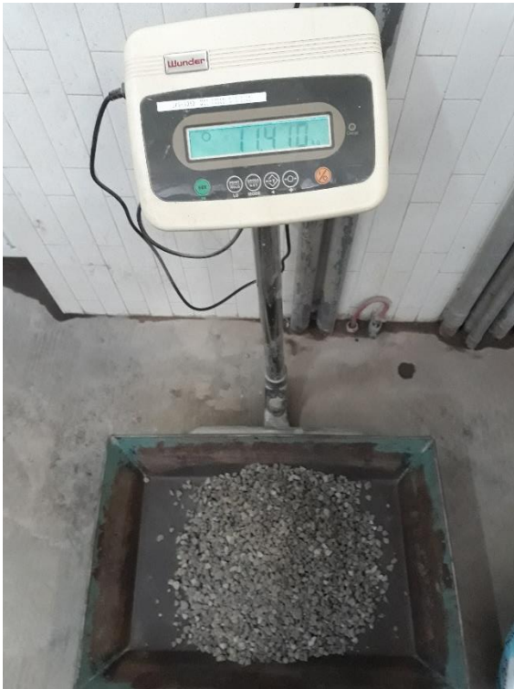
Figura 38. Pesado de grava (Fuente propia).
