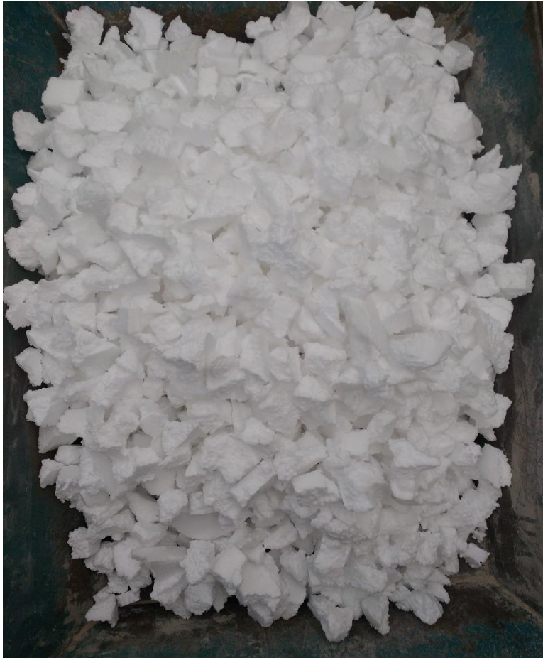
Figura 14. Espuma de EPS en fragmentos de 4 a 6 cm de diámetro listo para disolución (Fuente propia).
