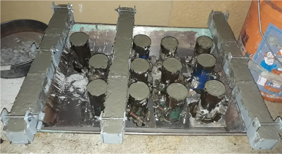
Figura 40. Cilindros y vigas de concreto simple recién colados (Fuente propia).
