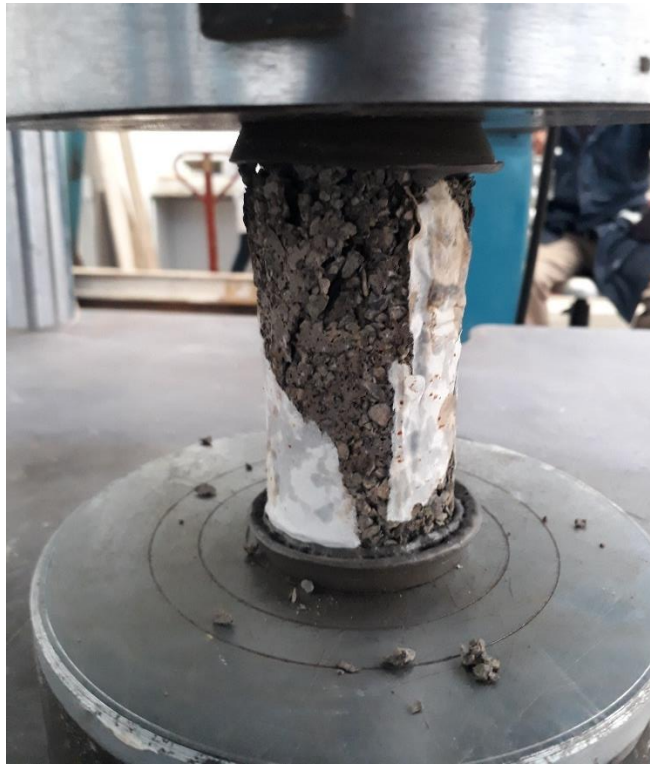
Figura 71. Falla de cilindro #2 de concreto base PL en prueba de compresión, agregado fino (Fuente propia).
