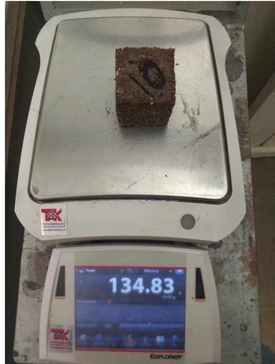
Figura 35. Pesado de cubo de mortero arena-PL después de la absorción (Fuente propia).
