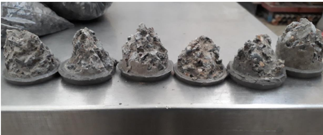
Figura 70. Restos de probetas de cilindros de concreto en prueba de compresión (Fuente propia).
