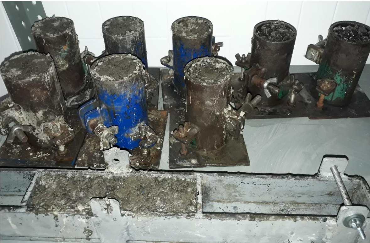
Figura 41. Cilindros y vigas de concreto a base de PL recién colados (Fuente propia).
