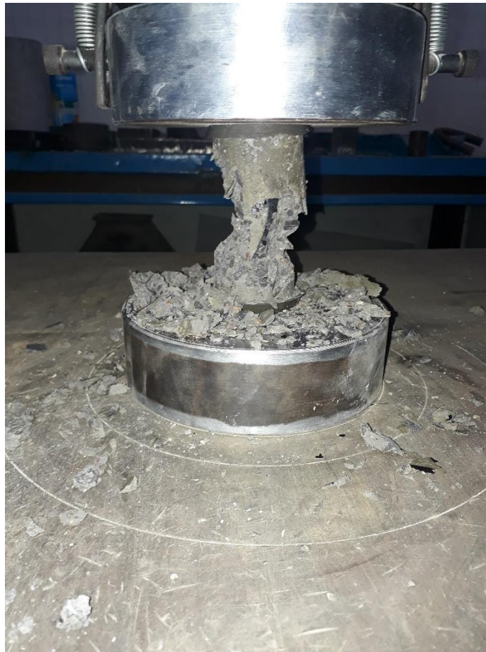
Figura 68. Falla de cilindro #2 de concreto en prueba de compresión (Fuente propia).
