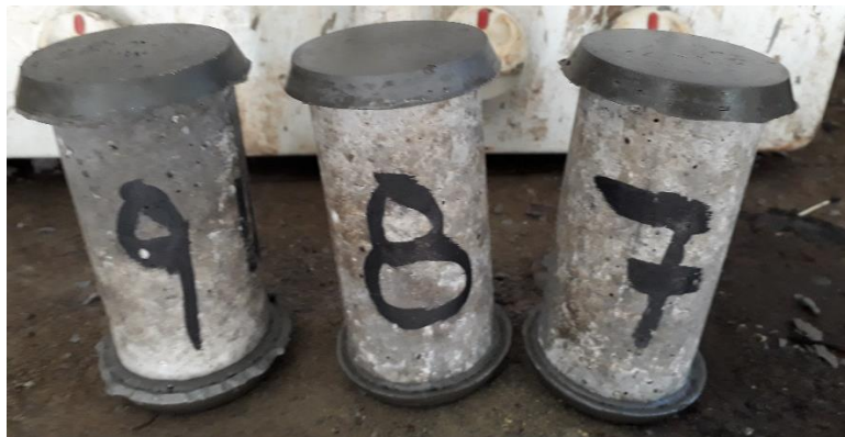
Figura 50. Cilindros cabeceados, concreto simple. (Fuente propia).
