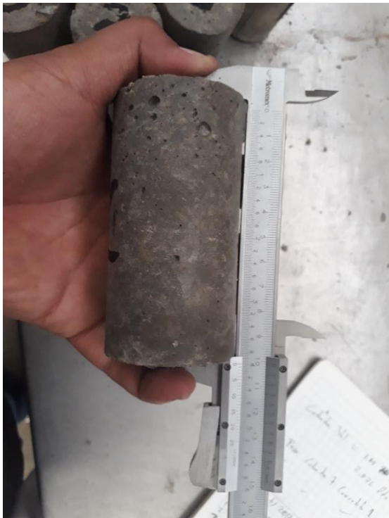
Figura 44. Medición de cilindro de concreto (Fuente propia).
