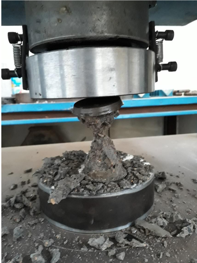
Figura 69. Falla de cilindro #4 de concreto en prueba de compresión (Fuente propia).
