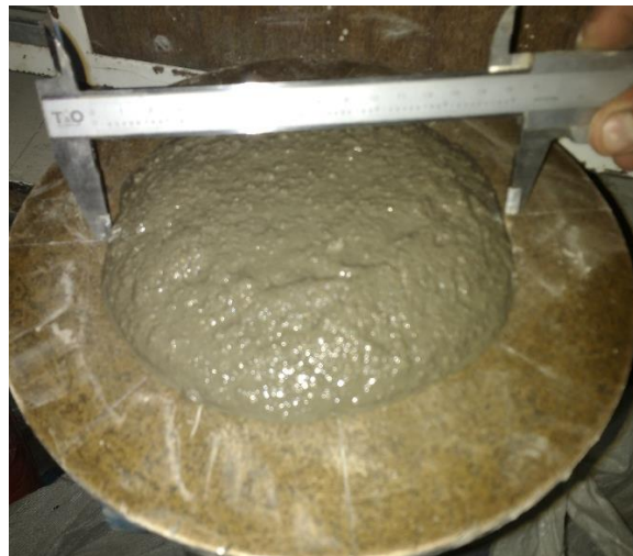
Figura 31. Masa de mortero expandida después del ensayo de fluidez (Fuente propia).
