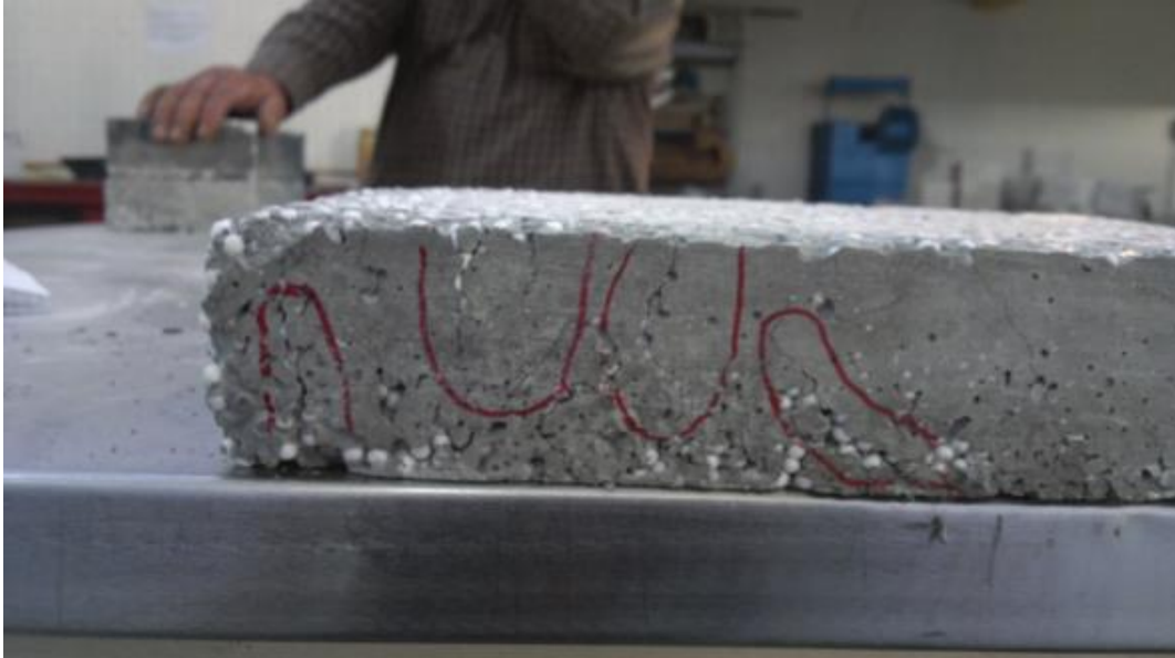
Figura 5. Grietas resultantes en el tabique después de prueba de compresión.
