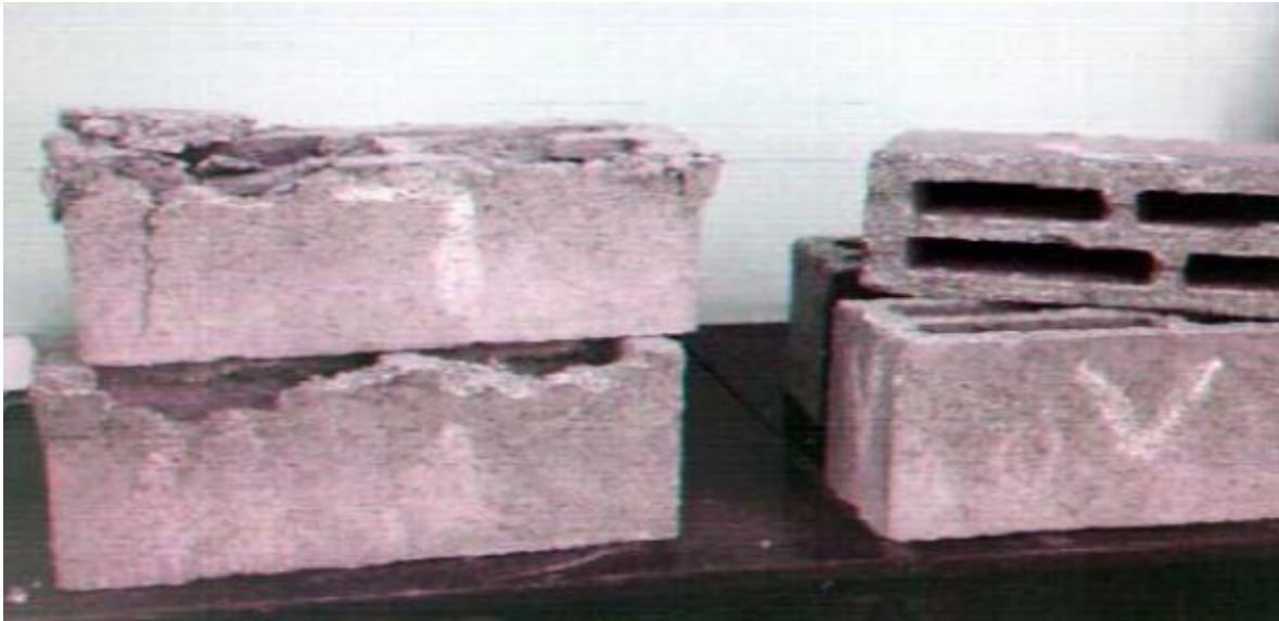
Figura 4. Modos de falla de bloques de mortero adicionado con poliestireno expandido, densidad de 1500 \text{ kg/m}^3 . Fuente: (Kuhail, 2001).
