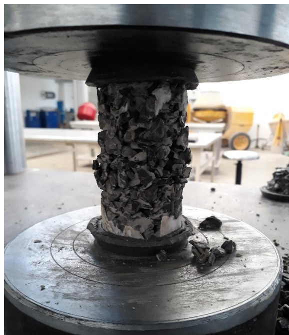
Figura 72. Falla de cilindro #6 de concreto base PL en prueba de compresión, agregado grueso (Fuente propia).
