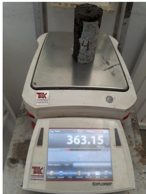
Figura 49. Pesado de cilindro de concreto grava-PL después de la absorción (Fuente propia).
