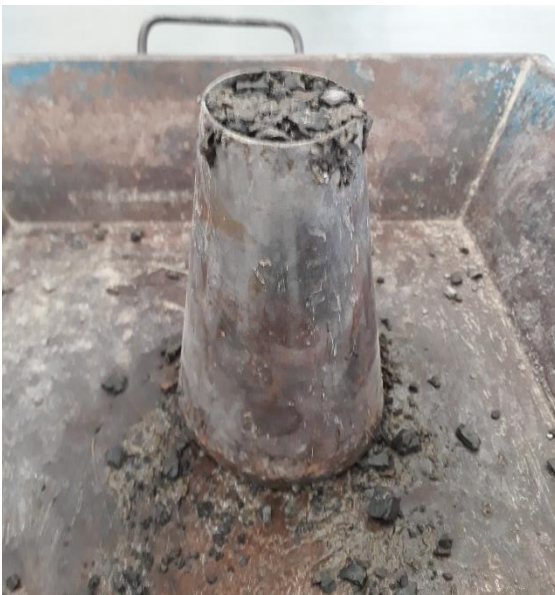
Figura 46. Llenado de cono de revenimiento (Fuente propia).
