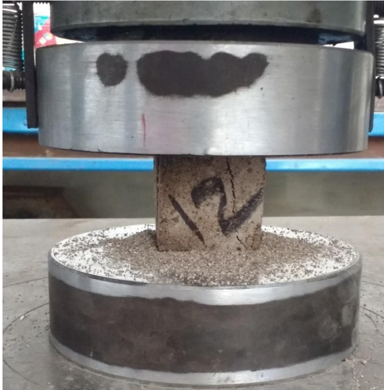
Figura 36. Prueba de compresión simple a cubo de mortero arena-PL (Fuente propia).
