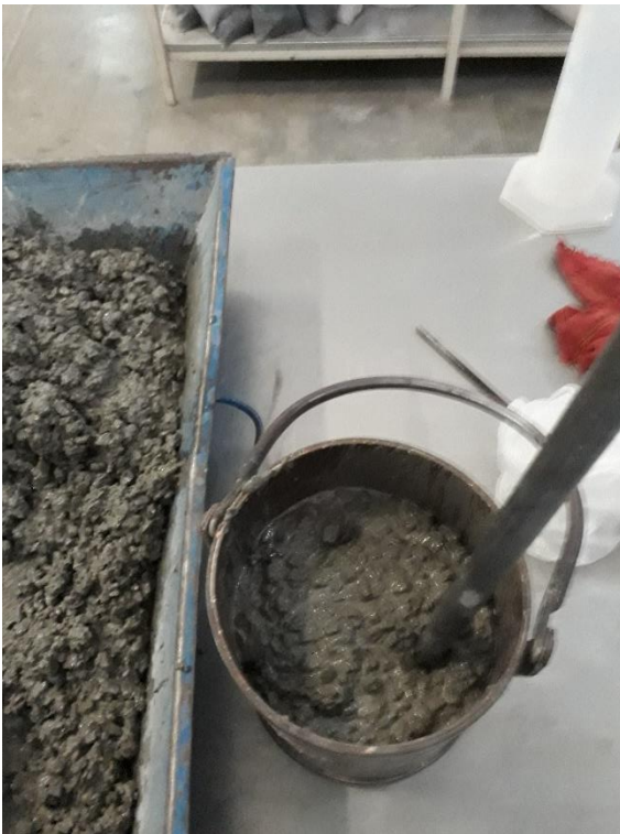
Figura 42. Varillado de concreto (Fuente propia).
