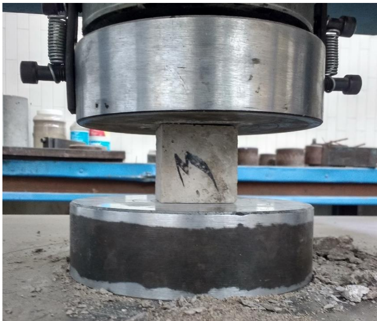
Figura 37. Prueba de compresión simple a cubo de mortero arena-cemento (Fuente propia).
