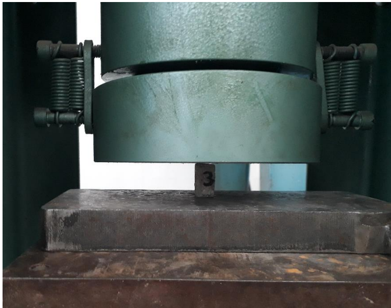
Figura 23. Prueba de compresión simple a probeta de PL (Fuente propia).
