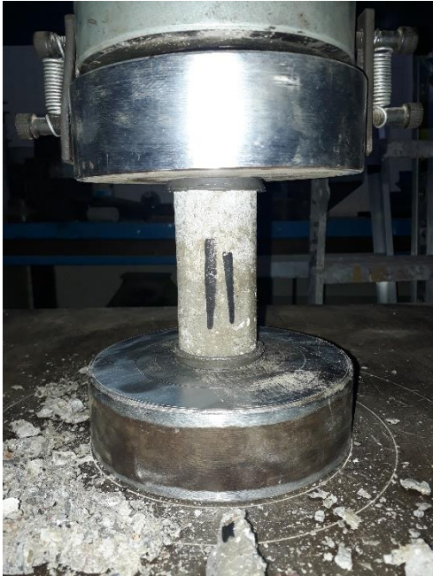
Figura 51. Prueba de compresión simple a cilindro de concreto base cemento portland (Fuente propia).
