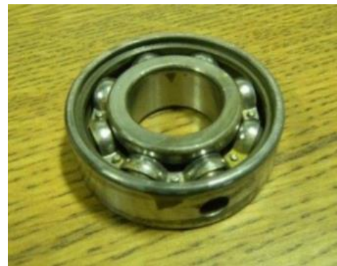
Figura 2.4. Rodamiento con falla en el anillo exterior.
