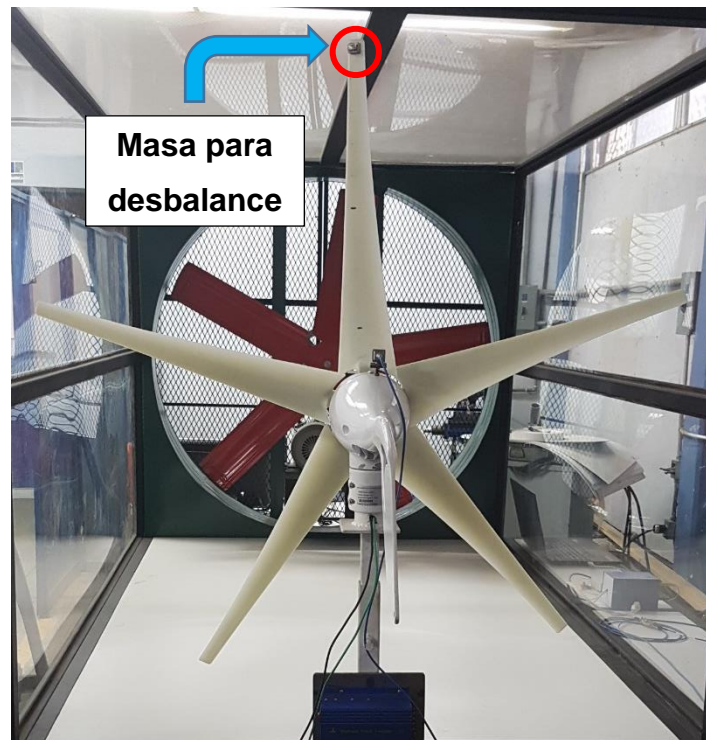
Figura 3.7. Aerogenerador con desbalance en un aspa.
