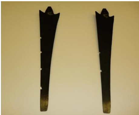
Figura 2.3. Aspas con fisuras en las orillas.
