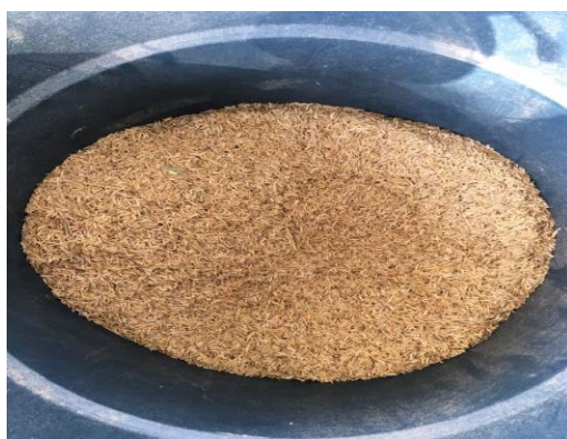
Figura 17. Cascarilla de arroz con humedad inicial de 8.2%
