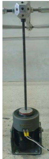
FIGURA 3.12. ELEMENTO EXCITADOR ACOPLADO A LA ESTRUCTURA.
