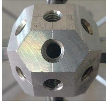
FIGURA 3. 3. NODO DE LA ESTRUCTURA.
