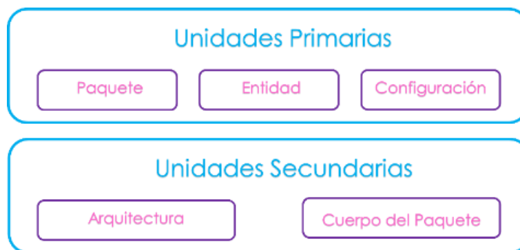
Figura 2.11 Diagrama a bloques de las entidades de VHDL Fuente: UAQ, 2016
