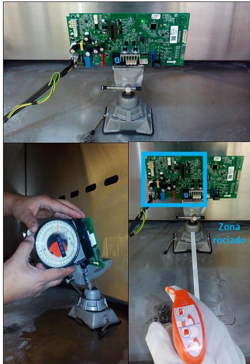
*Figura 27. Acomodo y zona de rociado en muestras de prueba de arco deléctrico.*
