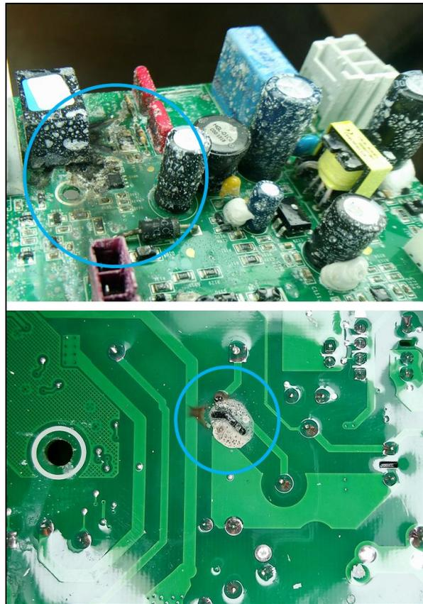
*Figura 29. Cortos y daños observados en muestras después de prueba de arco eléctrico (2).*
