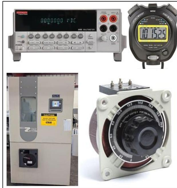
Figura 20. Equipos de control y medición para prueba de degradación acelerada (de arriba abajo y de izquierda a derecha: multímetro, cronómetro, cámara subzero y variac)
