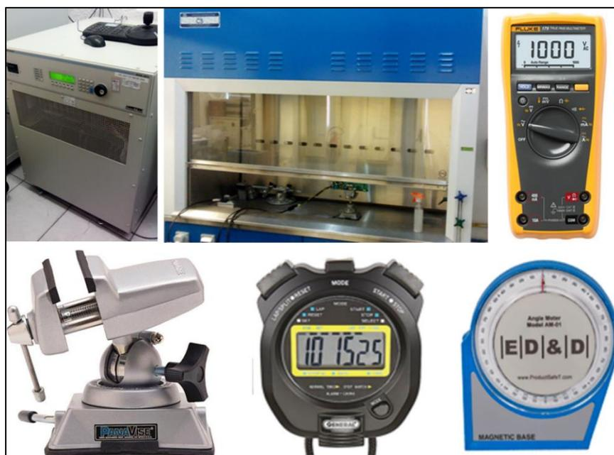
Figura 25. Equipos de control y medición para prueba de arco eléctrico (de arriba a abajo y de izquierda a derecha: fuente de energía, campana de laboratorio, multímetro, disp. de sujeción, cronómetro y medidor de ángulos).
