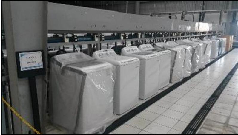
*Figura 19. Mesas de prueba del Laboratorio de Confiabilidad a nivel sistema en la empresa.*
