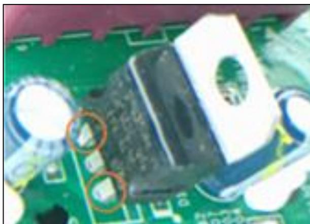
Figura 24. Tensión de salida tomada del transistor.
