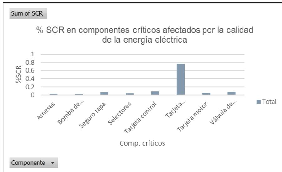
Figura 45. Principales componentes que afectan mayormente al SCR.
