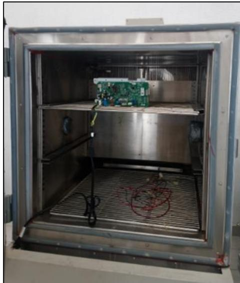
Figura 23. Acomodo de tarjetas electrónicas dentro de cámara de prueba.
