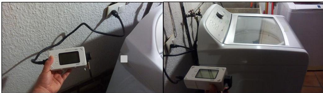
*Figura 13. Instalación de equipos de medición en lavadoras*
