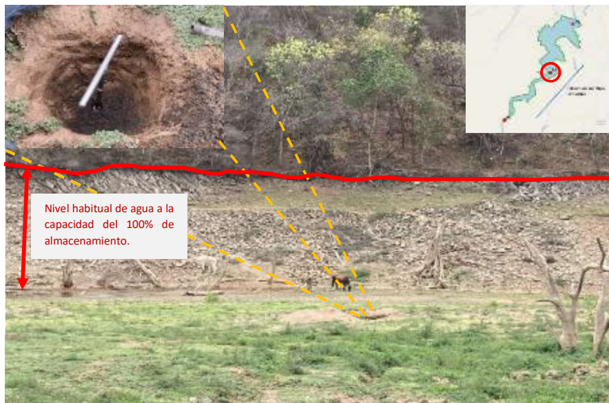
Figura 4. Punto dos de muestreo, punto medio longitudinal del embalse. Obtención de muestra mediante barreno muestreador.
