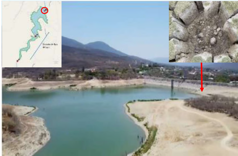
Figura 5. Punto de muestreo número tres, a la salida del embalse, sedimento compactado y agrietado formando bloques prismáticos en el estrato superior. Fotografía aérea cortesía de Isaías Cruz.
