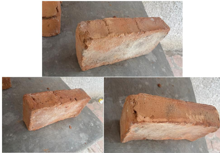
Figura 3-20. Tabiques rojos recocidos en horno convencional de la prueba M1.
