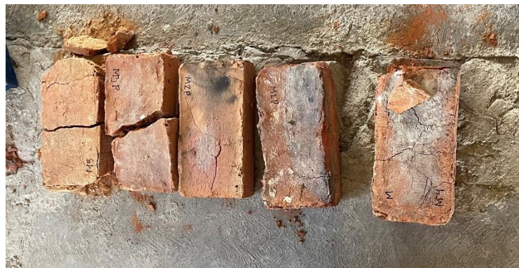
Figura 3-24. Ladrillos sometidos a la prueba mecánica.
