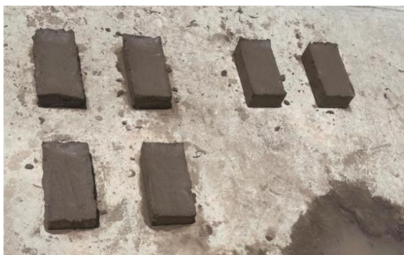
Figura 3-18. Proceso de secado de los tabiques moldeados.
