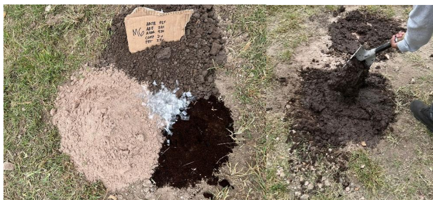
Figura 3-10. Disposición de los materiales para la mezcla M6 y su integración.
