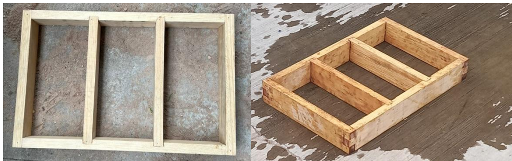
Figura 3-4. Moldes fabricados para generar los tabiques con medidas específicas.
