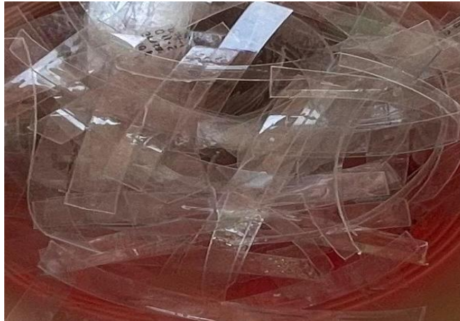
Figura 3-6. Fibras de PET cortadas ara la mezcla.
