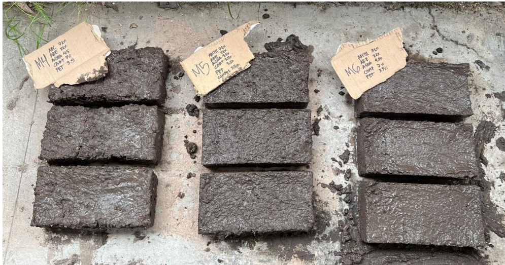
Figura 3-13. Primeras 3 Pruebas desmoldadas y próximas al proceso de secado.
