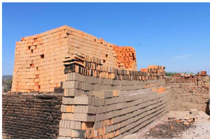
Figura 1-2. Horno tabiquero artesanal. Fotografía propia, 2024.
