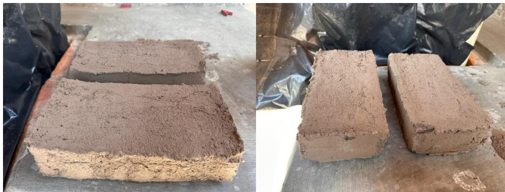
Figura 3-19. Tabiques secos y próximos a su proceso de cocción.
