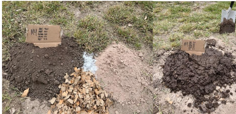
Figura 3-8. Disposición de los materiales para la mezcla M4 y su integración.
