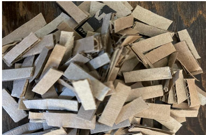
Figura 3-7. Fibras de Cartón cortadas para la mezcla.
