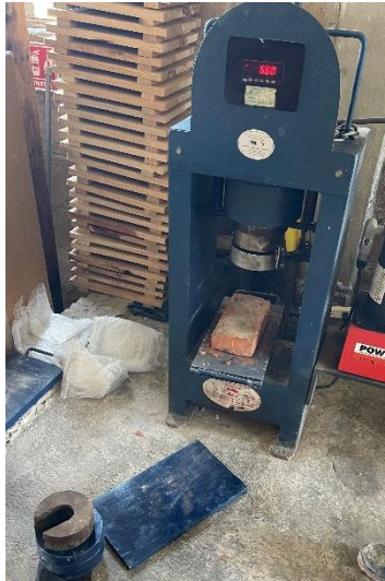
Figura 3-22. Maquina universal utilizada en las pruebas mecánicas.
