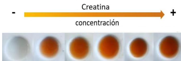
Fig. 47. Muestras colorimétricas de creatina (creatinasa) en cerámica.
