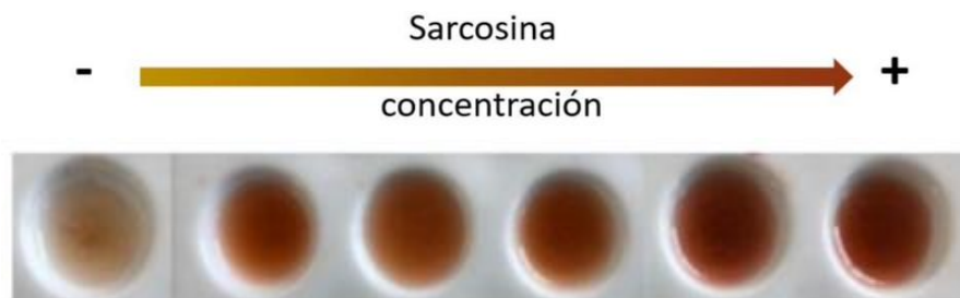
Fig. 51. Muestras colorimétricas de sarcosina (sarcosina oxidasa) en cerámica.
