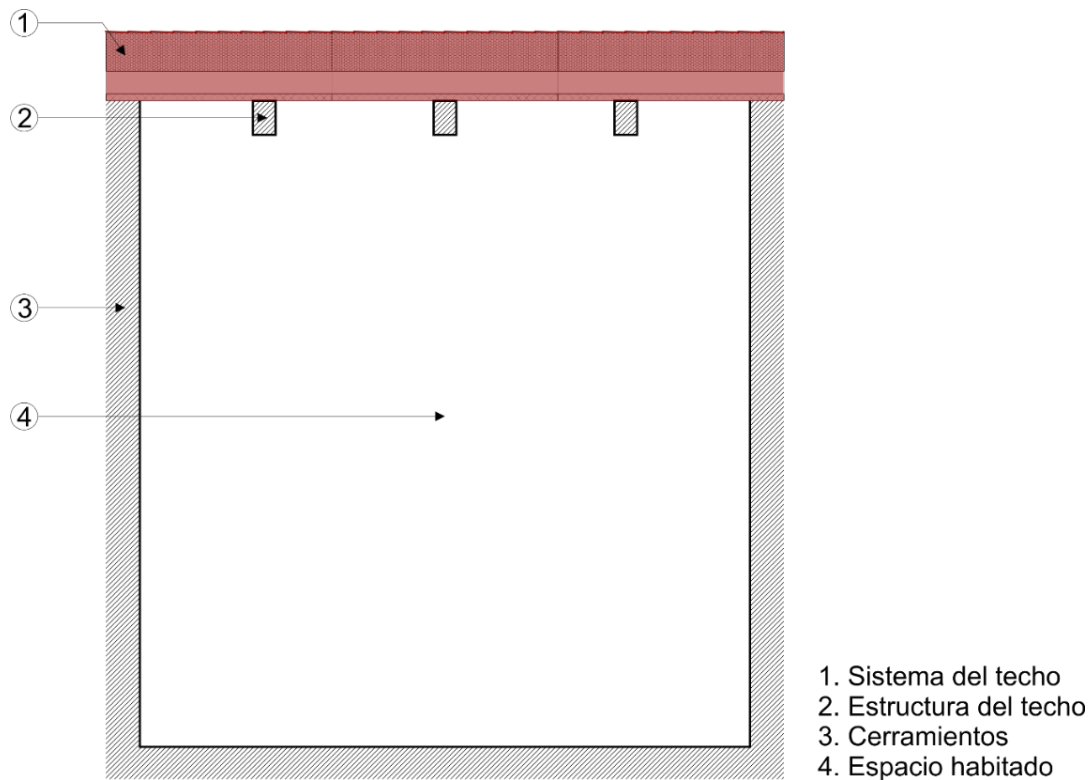
Figura 7.1. Colocación del sistema de techo.
