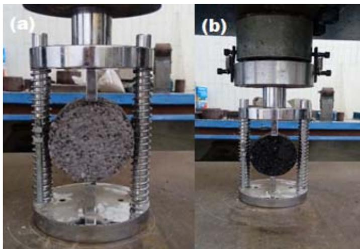
**Figura 3.10 Tensión indirecta (a) polímero reciclado y (b) asfalto.**
