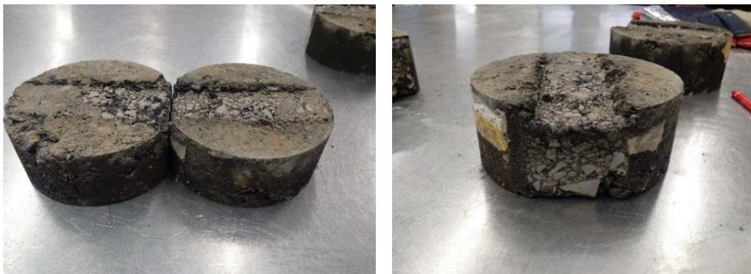
**Figura 3.39 Profundidad de ahuellamiento de la mezcla asfáltica.**
