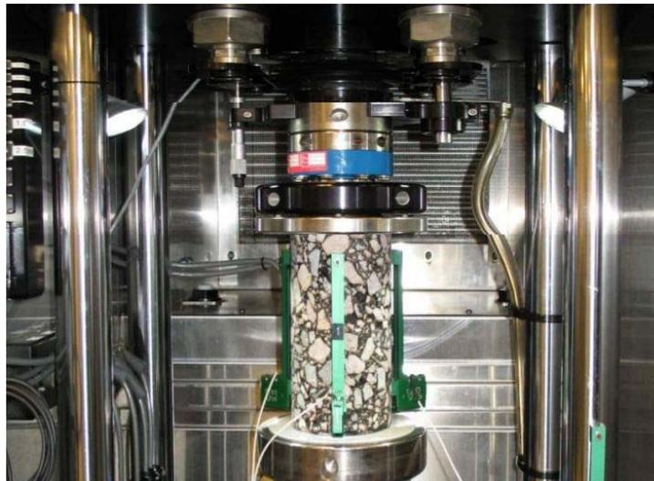
**Figura 3.22** Módulo dinámico (muestra de control).
