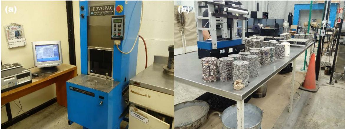
**Figura 3.19 Equipo (a) compactador giratorio y (b) muestras de control.**
