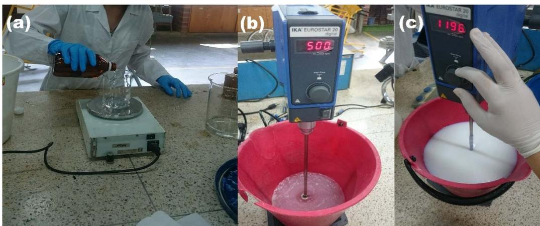
**Figura 3.3 Reacción química del polímero (a) sustancias químicas, (b) agitación y reflujo continuo y (c) concentración del aglutinante.**
