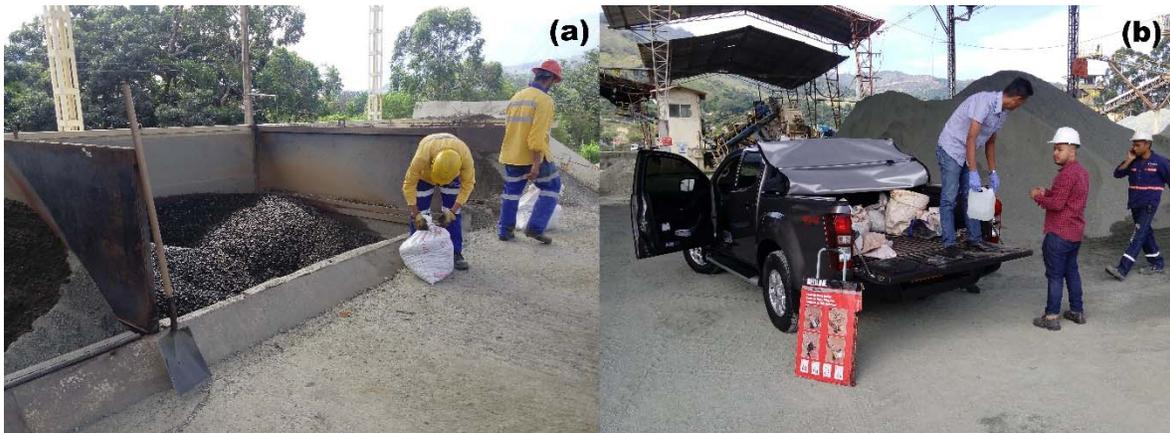
**Figura 3.5 Muestreo (a) extracción e identificación y (b) transporte de los agregados.**
