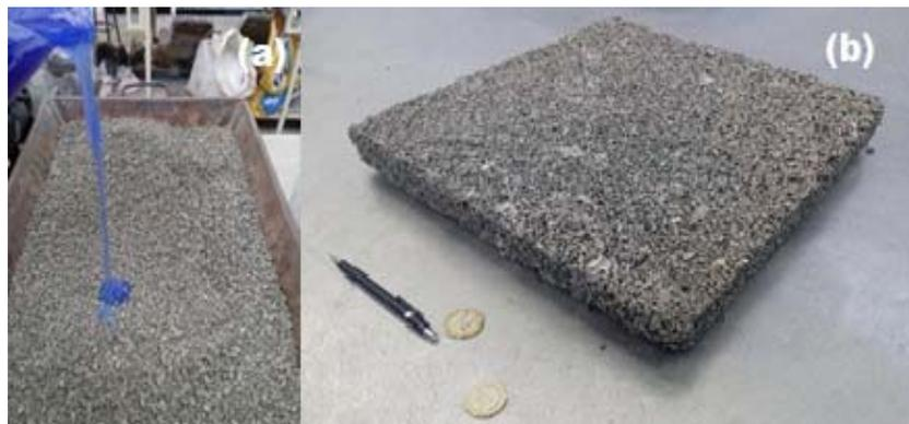
**Figura 3.12 Tasa de infiltración (a) elaboración de la probeta y (b) prototipo.**
