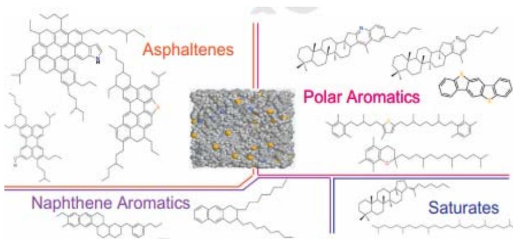
**Figura 2.7 Estructura molecular de los asfaltos.**
