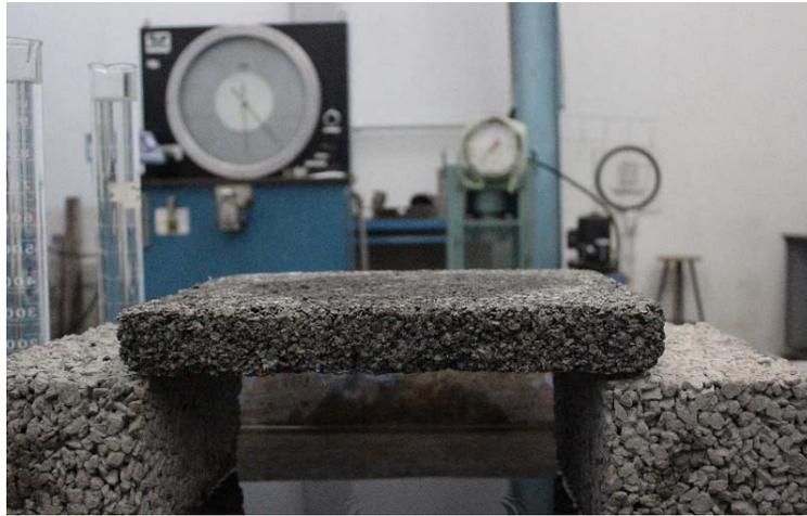
**Figura 3.13 Instalación de muestra para determinar la tasa de infiltración.**
