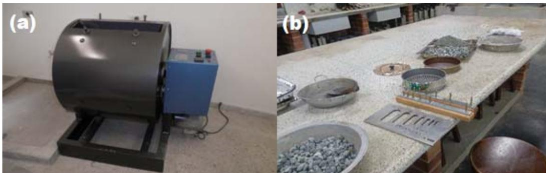
**Figura 3.7 Ensayos de calidad (a) desgaste de los ángeles y (b) partículas planas y alargadas.**
