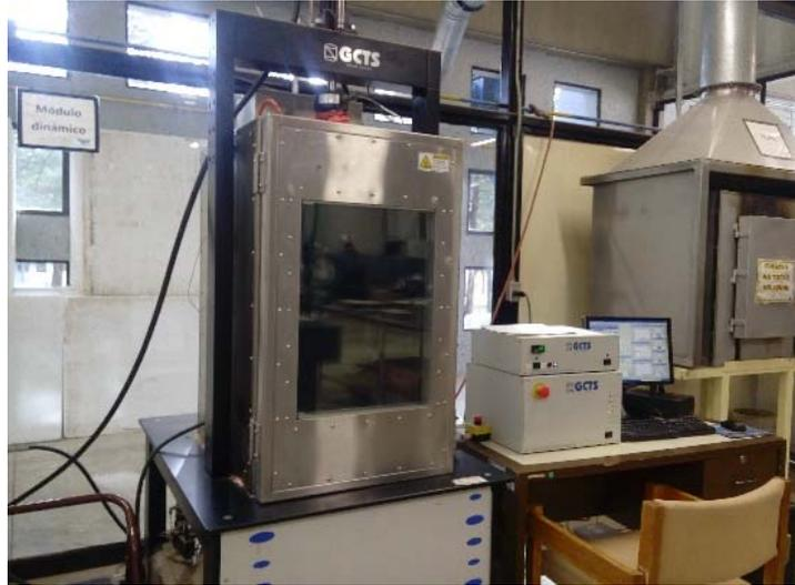
**Figura 3.21** Equipo electrohidráulico con generador de onda.
