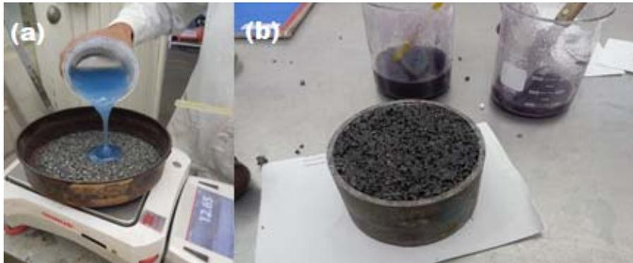
**Figura 3.9 Preparación de especímenes (a) polímero reciclado y (b) asfalto.**
