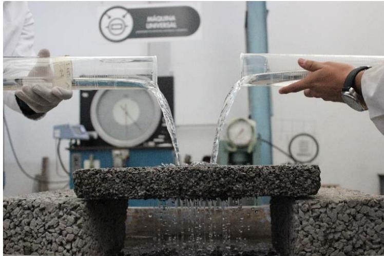
**Figura 3.35 Permeabilidad de la mezcla reciclada.**
