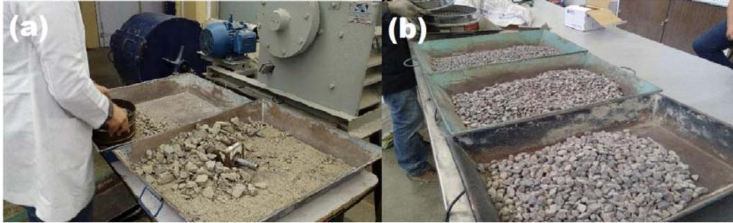
**Figura 3.6 Caracterización del agregado (a) cribado del material y (b) granulometría.**
