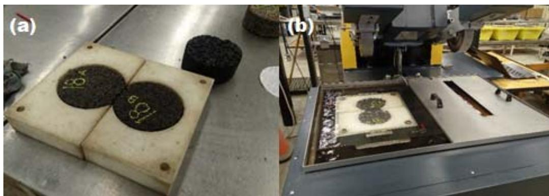
**Figura 3.16 Rueda cargada de Hamburgo (a) especímenes y (b) configuración de equipo.**
