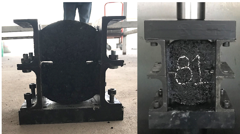
Figura 4.4. Montaje de las probetas en el sistema de evaluación a tensión directa. Fuente: Elaboración propia
