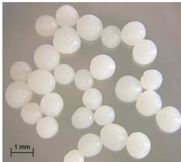
Figura 13. Fotografía de microcápsulas monocapa (Alg-Na) cargadas con LG C1119. La imagen se capturó en un estereomicroscopio (Modelo EZ4 D, Leica). Barra de escala = 1 mm.
