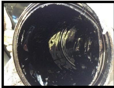
Figura 5. Asfalto AC-20, T=80 °C (CFATA, UNAM)
