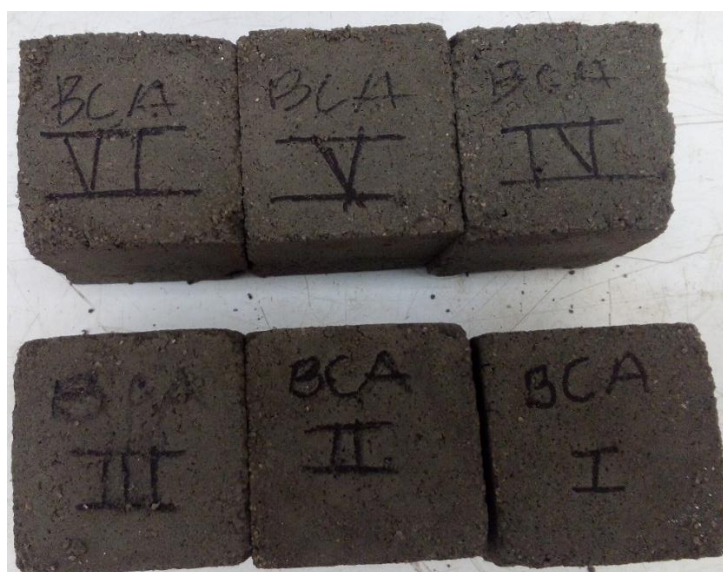
Figura 5.14 Especímenes de mortero. Mezcla de ensayo A (ceniza-cemento)
