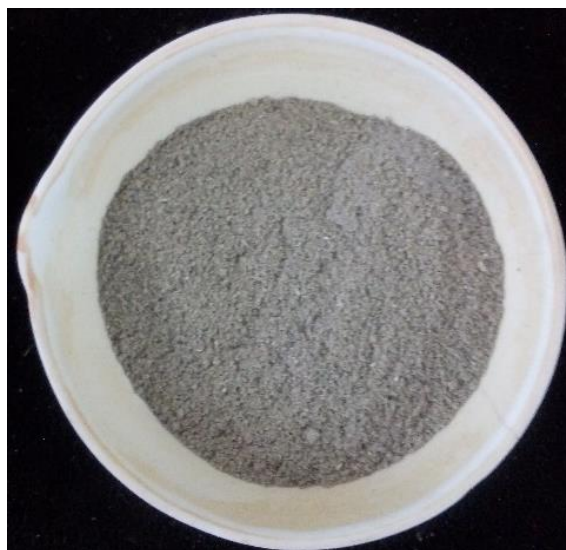
Figura 4.1 Producto de incineración de material crudo, 600°C durante 6 horas.
