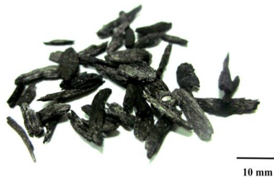
Figura 2.3 Partículas fibrosas y finas presentes en las muestras de BA (Bahurudeen et al., 2015)
