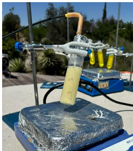
Figura 15. Montaje experimental para fotorreducción de \text{CO}_2 con luz solar.
