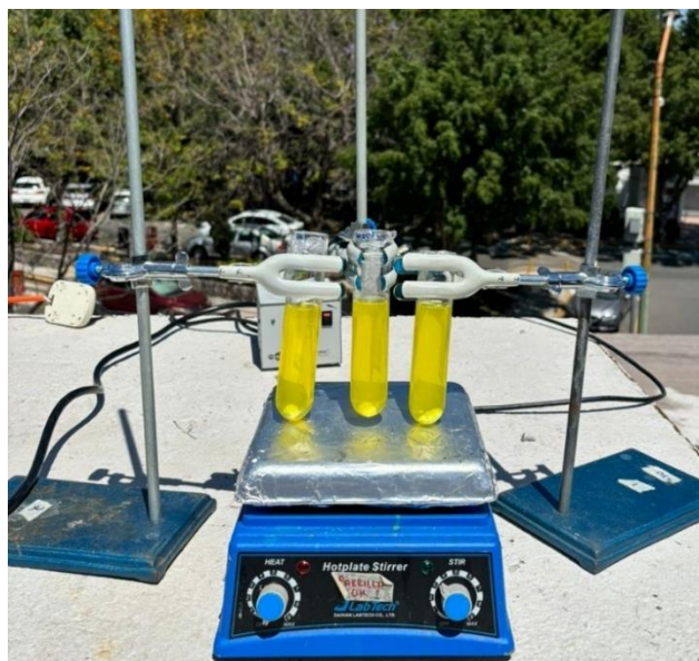
Figura 12. Montaje experimental para las pruebas de fotodegradación de tartrazina.
